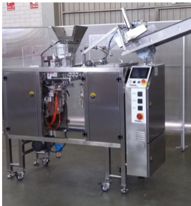
Imagen 7. Envasadora Doy Pack, modelo ITKP-PBP-300-DOY, fabricante Pymar Group
