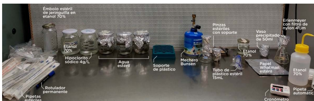
Figura 8 – Fotografía de la cabina de flujo laminar con el material necesario antes de empezar el cultivo de microsporas
