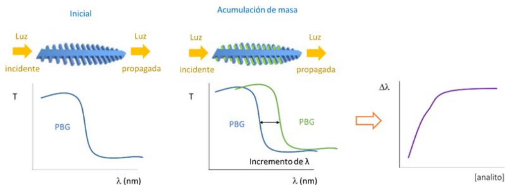
Figura 1.9. Representación esquemática de las medidas en estructuras de PBG. La onda evanescente interactúa con la materia de la superficie, lo cual modifica la luz que viaja dentro de la guía de onda, provocando un desplazamiento del PBG a longitudes de onda mayores.
