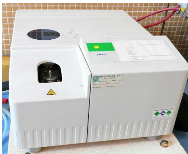
Figura 28. Equipo calorimetría diferencial de barrido (DSC) empleado en la obtención de las transiciones térmicas
