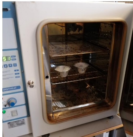
Figura 16. Fotografía del proceso de secado del HNTs y DE en un horno convencional
