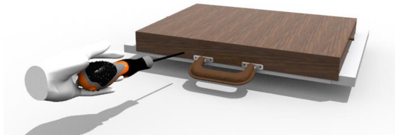
Ilustración 44: Ensamblaje del asa con el maletín parte 2
