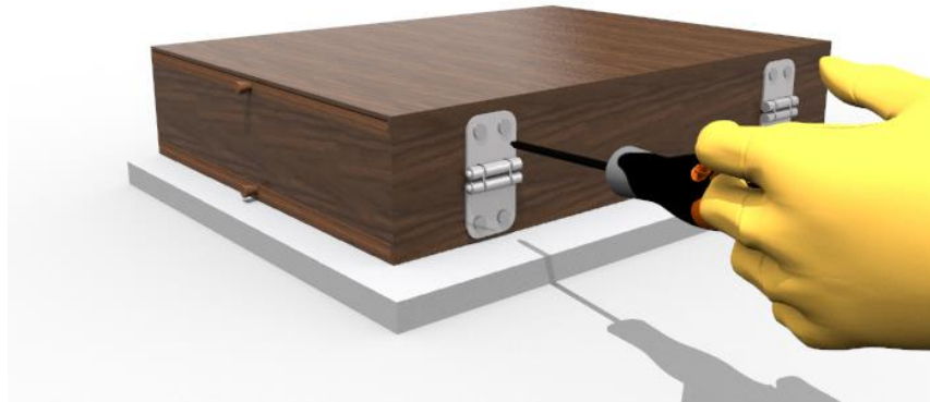
Ilustración 48: Ensamblaje de las bisagras mediante tornillería
