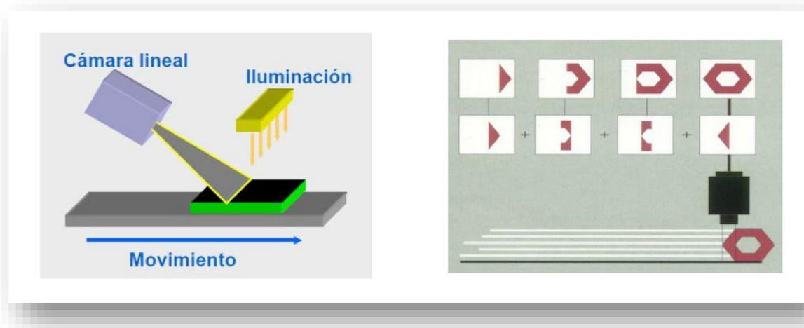
Figura 2-2. Funcionamiento cámara sensor lineal. Imagen extraída de [\[3\]](#).
