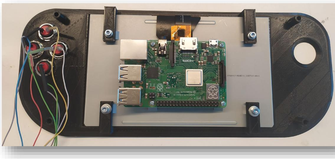
Figura anexos-3. Montaje parte superior del mando de control.
