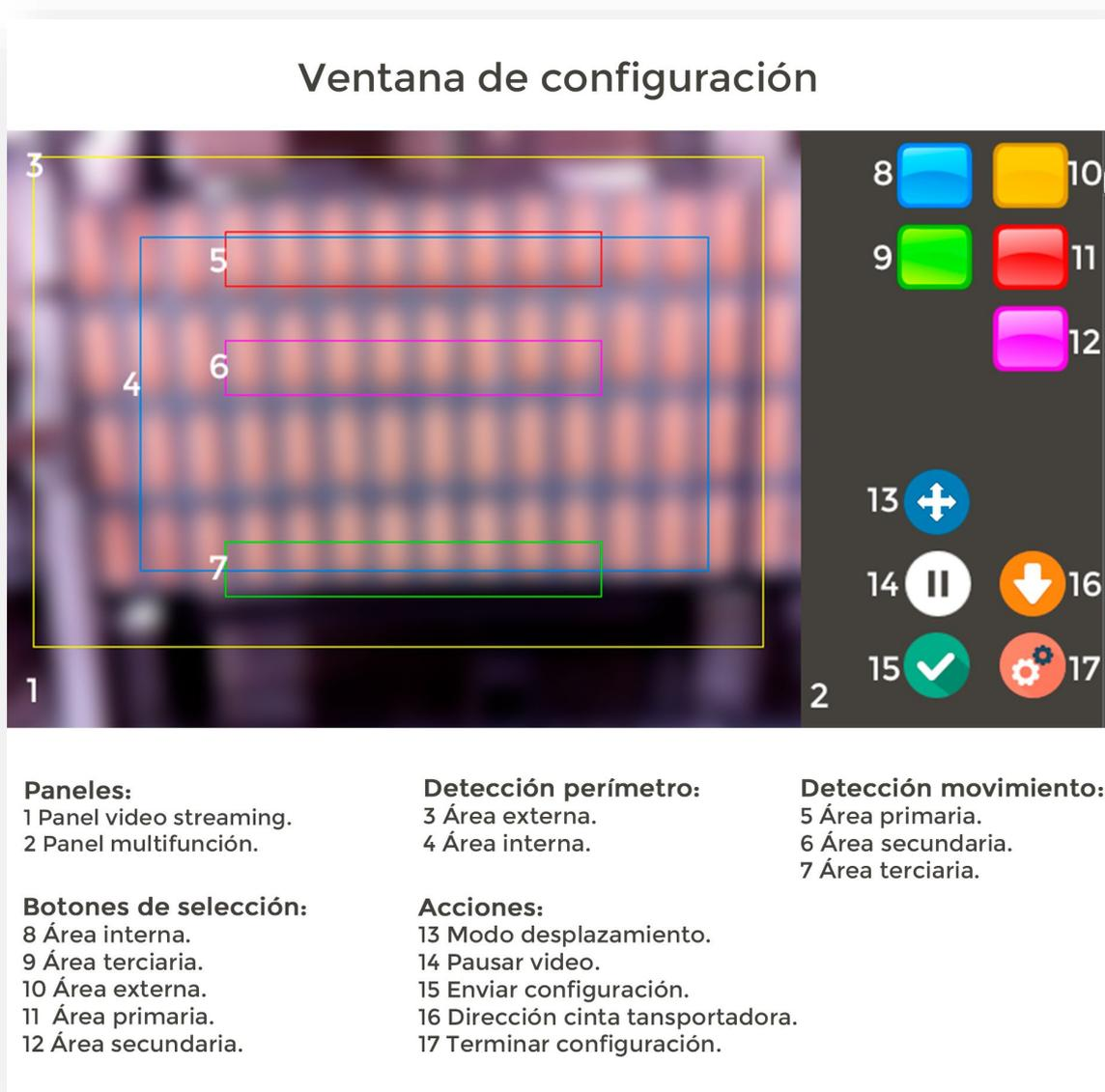
Figura 5-11 Ventana de configuración del sistema.
