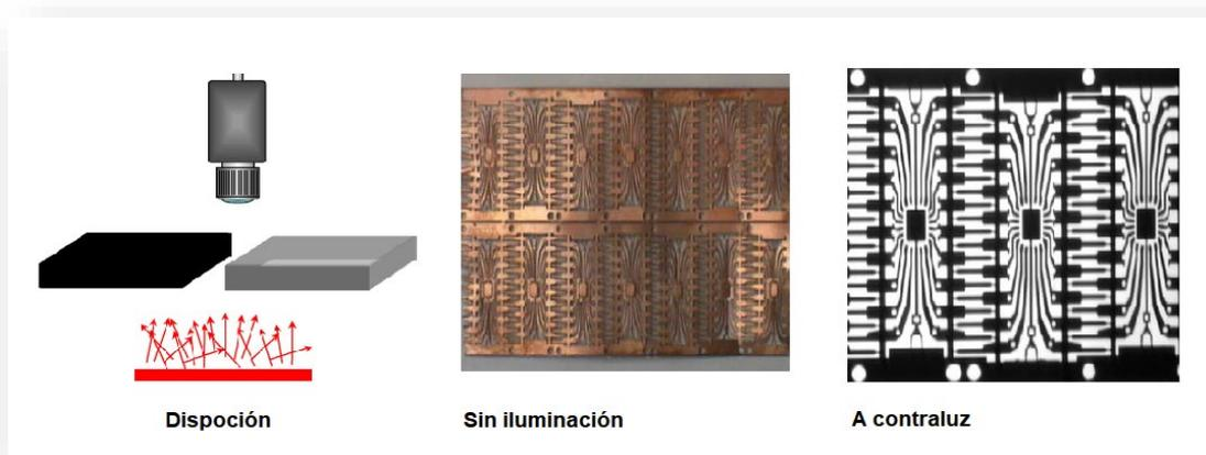
Figura 2-8. Iluminación a contraluz. Imagen extraída de [3].
