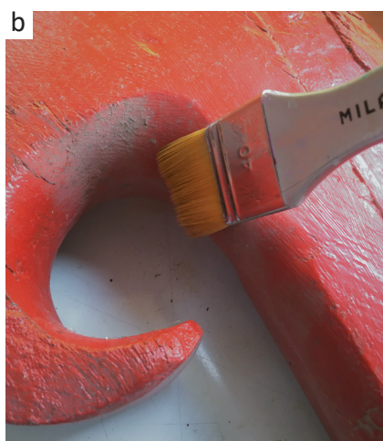
Fig. 28 (a-b). Proceso de limpieza mecánica en seco a través de brocha
