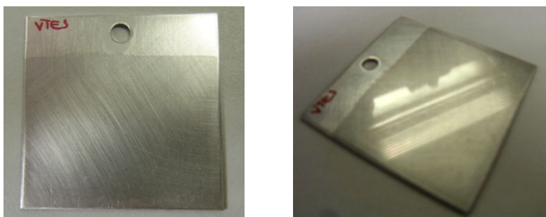
Figura. 4.1 (Izq.) Ejemplo de plancha recubierta con el recubrimiento VTES mediante la técnica dip-coating . (Dcha.) reflejo tipo espejo sobre la superficie del recubrimiento VTES.
