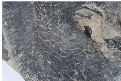
Fig. 7. Craqueladuras en la pátina de color.
