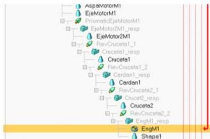
Ilustración 42 Unión cadena cinemática entre el sistema de cardan y base inferior
