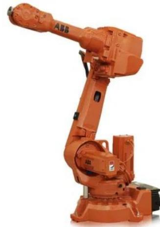
*Ilustración 3 Robot serial*
