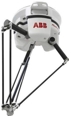
*Ilustración 4 Robot paralelo*
