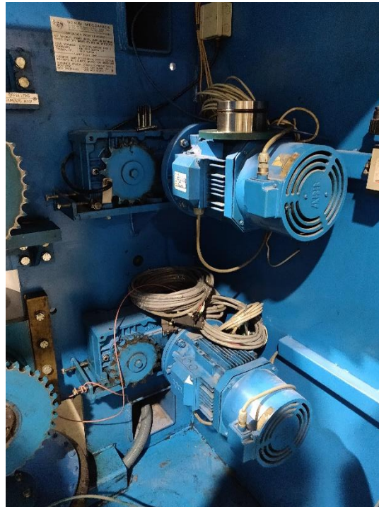
Fig. 9 Motores que hacen rotar los cilindros
