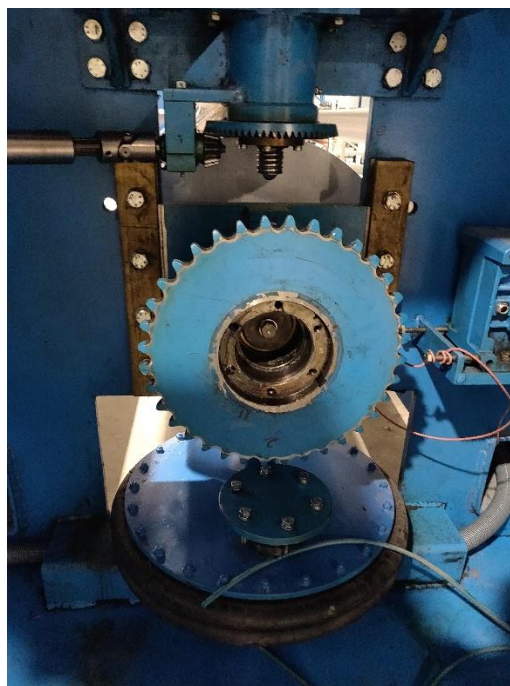
Fig. 10 Parte inferior de la foto se observa el globo deshinchado que levanta el cilindro, en la parte superior se ve el sinfín que ajusta la altura.
