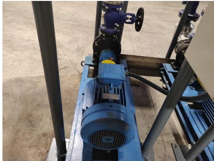
Fig. 4 Bomba de inyección de aceite de la calandra
