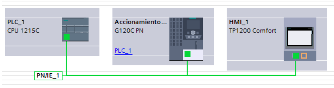
Fig. 21 Red PROFINET formada por el PLC, variador y pantalla del proyecto
