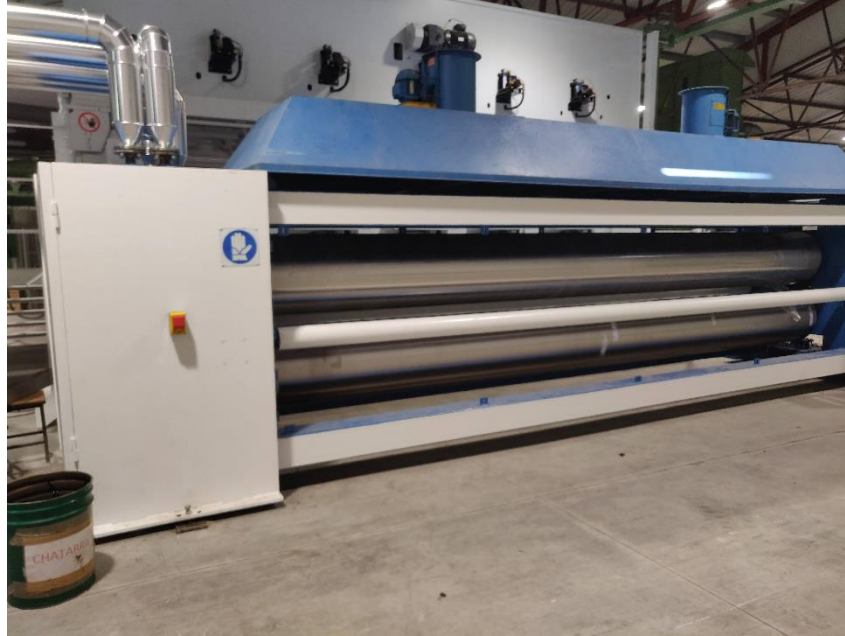
Fig. 6 A la izquierda se observa las dos tuberías de entrada de aceite
