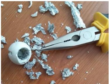
Fig. 36, 37 y 38. Proceso de creación de las bolas para las articulaciones
