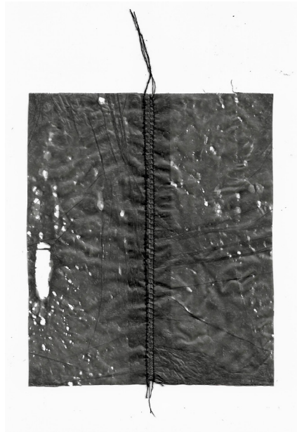
Fig. 21 y 22 Pruebas de plástico superpuesto mediante calor y su posterior pespun-teado en máquina plana.
