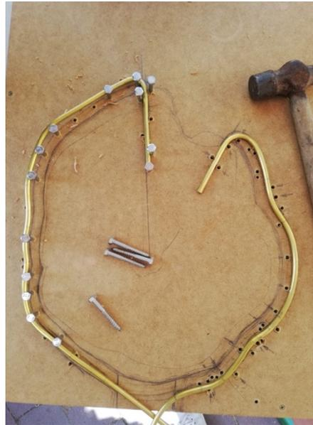
Fig. 38 Proceso de construcción. Moldeado del latón, 2020.
