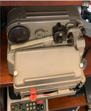
Fig. 9 a) Teletipo Siemens.
