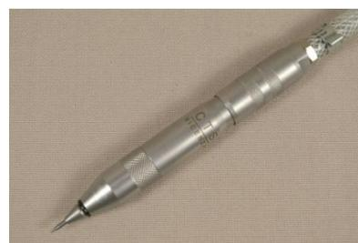
*Figura 34. Imagen de la parte de la punta un vibroincisor con puntas de widia.*
