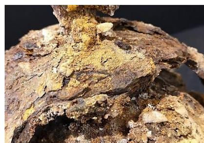
Figura 30. Fotografía detalle de las laminaciones y grietas en la parte superior de la pieza.
