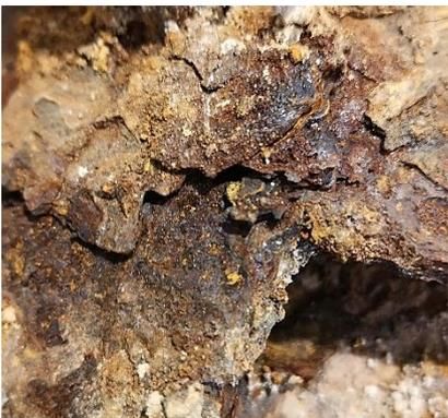
Figura 28. Fotografías detalle de los daños de laminaciones en la parte superior y central de la pieza.
