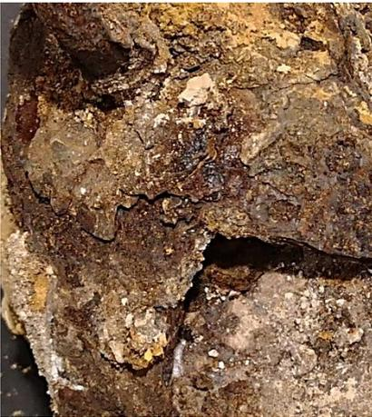
Figura 27. Fotografía detalle de los cloruros de hierro presentes en la obra.
