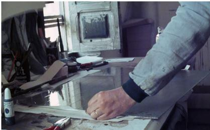
Fig. 64. Protección de la parte trasera de la plancha con cinta autoadhesiva de plástico.
