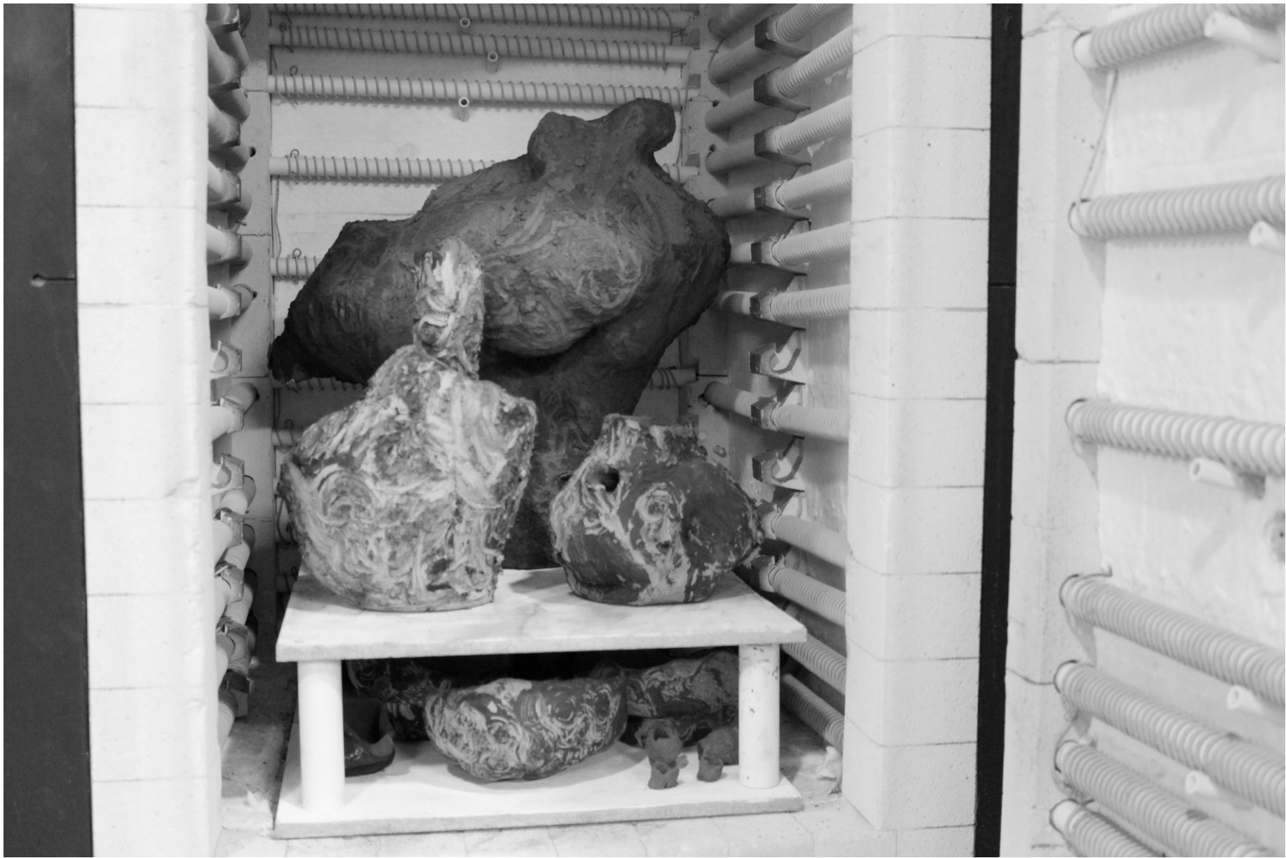
Figura 22. Horno estibado para el bizcochado.
