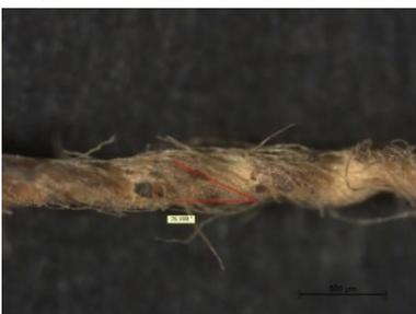
**Figura 23.** Detalle de la torsión de la muestra de hilo de trama. Microscopio óptico binocular, modelo S8PA0 de la marca Leica, luz incidente, cámara digital MC170HD y software LAS, 25x.
