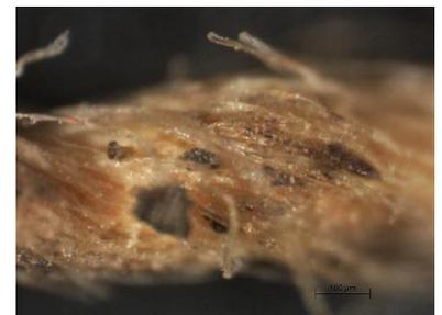
Figura 38. Detalle de la preparación en la muestra de hilo de trama. Microscopio óptico binocular, modelo S8PA0 de la marca Leica, luz incidente, cámara digital MC170HD y software LAS, 80x.
