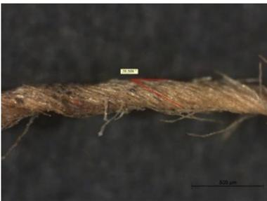
**Figura 21.** Detalle de la torsión de la muestra de hilo de urdimbre. Microscopio óptico binocular, modelo S8PA0 de la marca Leica, luz incidente, cámara digital MC170HD y software LAS, 32x.
