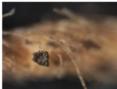
Figura 37. Detalle de la preparación en la muestra de hilo de trama. Microscopio óptico binocular, modelo S8PA0 de la marca Leica, luz incidente, cámara digital MC170HD y software LAS, 80x.
