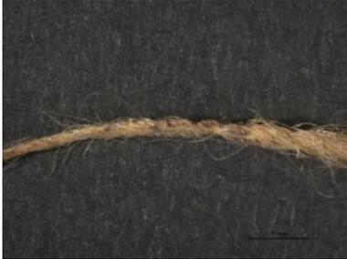
**Figura 20.** Muestra de hilo de urdimbre. Microscopio óptico binocular, modelo S8PA0 de la marca Leica, luz incidente, cámara digital MC170HD y software LAS, 10x.
