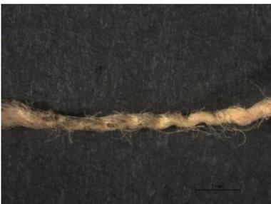
**Figura 22.** Muestra de hilo de trama. Microscopio óptico binocular, modelo S8PA0 de la marca Leica, luz incidente, cámara digital MC170HD y software LAS, 10x.
