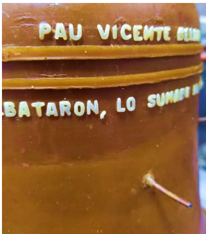
Fig. 35. VICENTE, P. Aplicació de lletres a la campana sobre cera de fundició. Pasta alimentària. Curs 2019-2020.
