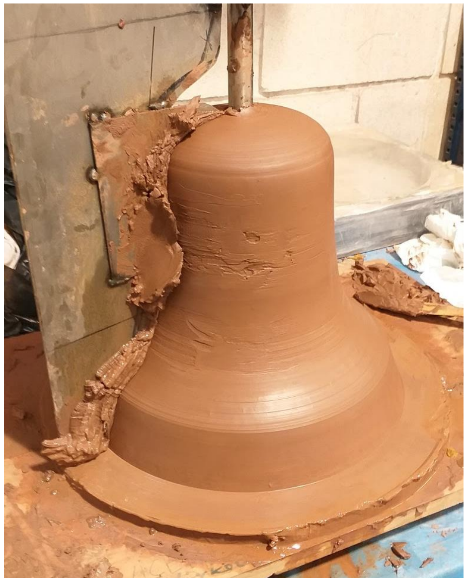
Fig. 27. VICENTE, P. Sistema de gir, forma de la campana. Fang. Curs 2019-2020.
