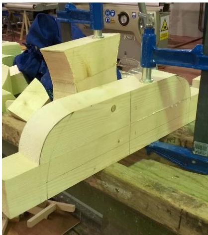
Fig. 51. VICENTE, P. Realització de la truja de la campana . Fusta. Curs 2019-2020.
