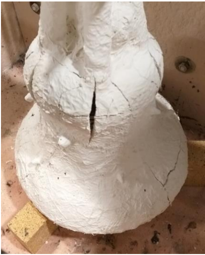
Fig. 43. VICENTE, P. Escletxes de trencament de la closca per la contracció del metall al refredar-se. Curs 2019-2020.
