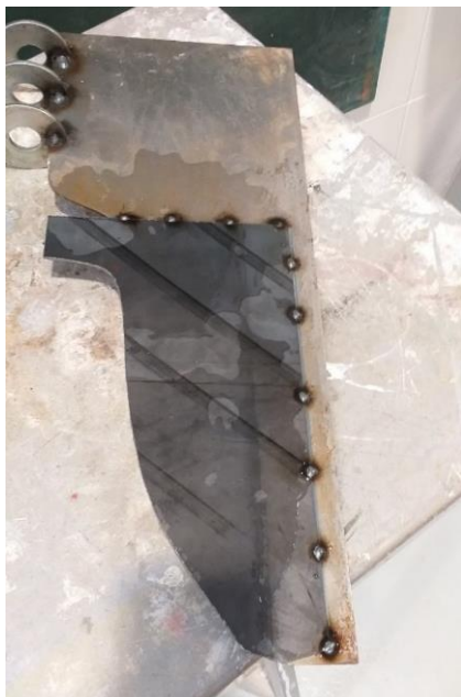
Fig. 29. VICENTE, P. Unió de planxa per a traure el negatiu de l'interior de la campana. Ferro i soldadura. Curs 2019-2020.
