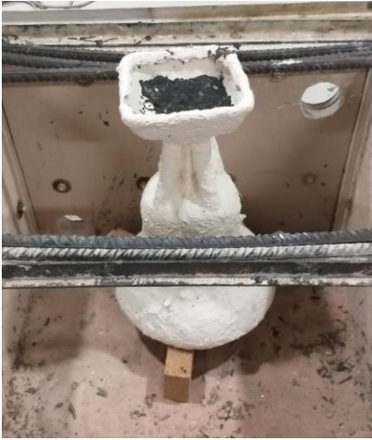
Fig. 44. VICENTE, P. Estat de la campana posteriorment a la colada. Curs 2019-2020.
