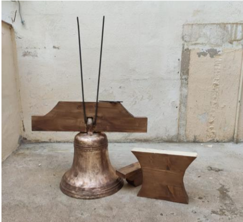
Fig. 55. VICENTE, P. Montaje de la campana amb la truja . Fusta i bronze. Curs 2019-2020.
