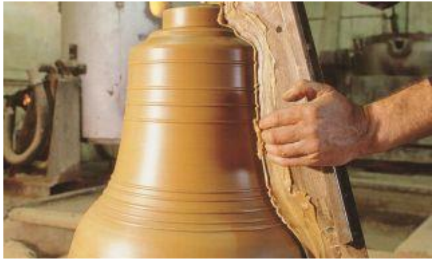
Fig. 3. SOA, S. Modelatge campana amb cera. Yauhquemehcan. 2017.
