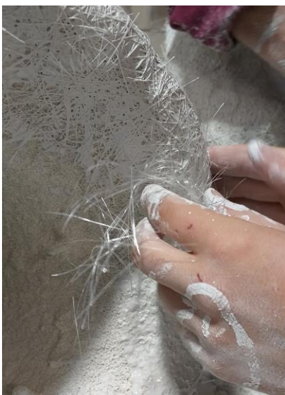
Fig. 39. VICENTE, P. Aplicació de fibra de vidre a la campana. Curs 2019-2020.
