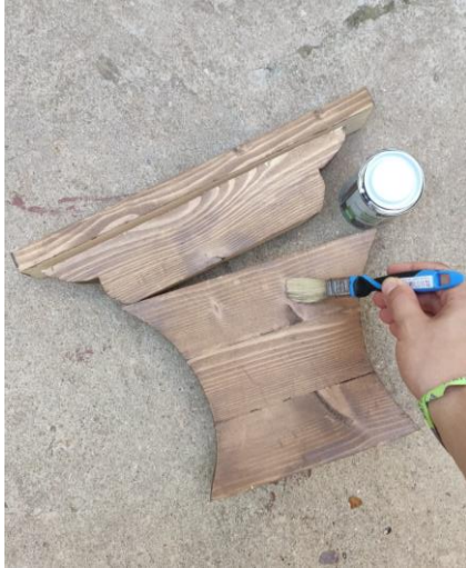
Fig. 54. VICENTE, P. Varnizat de la truja de la campana . Curs 2019-2020.
