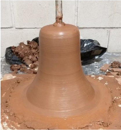
Fig. 30. VICENTE, P. Negatiu de l' interior de la campana . Fang. Curs 2019-2020.
