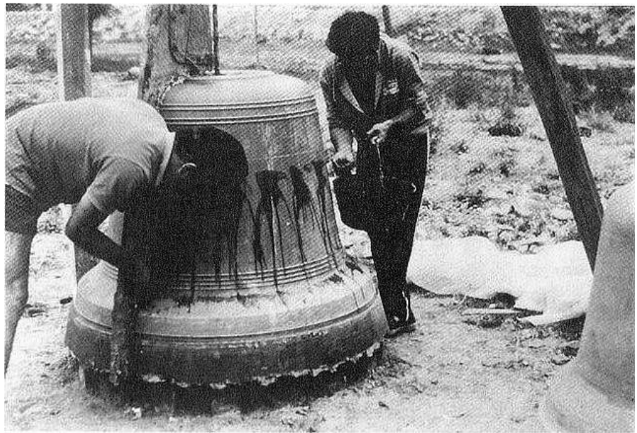
Fig. 9. CABRELLES, J. Construint campana falsa . Empresa Portilla Limitada S.A. 1990.
