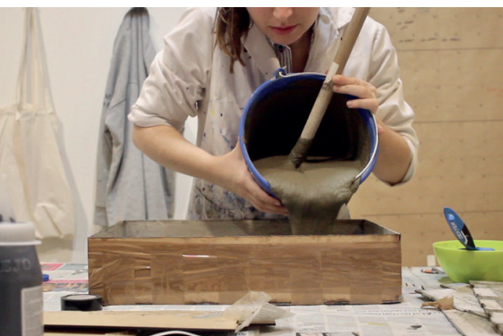
Fig. 56 Vertido de cemento sobre molde en DM para crear la caja contenedora
