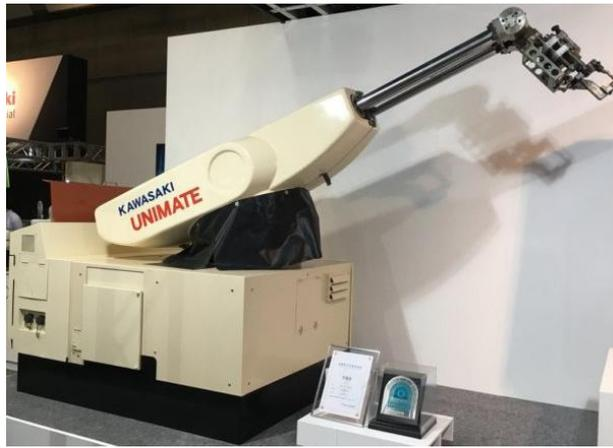
*Ilustración 1. Robot Unimate. Uno de los primeros brazos robóticos industriales.*
