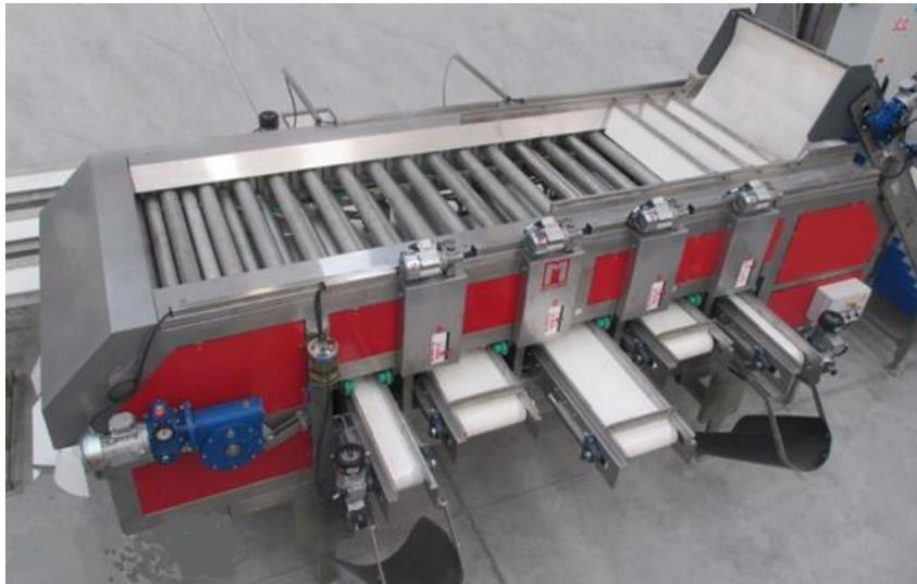
Fig. 1. Calibradora diametral mecánica [1].
