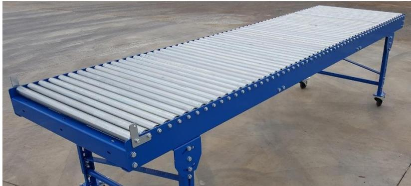
Fig. 9. Transportador de rodillos [27].
