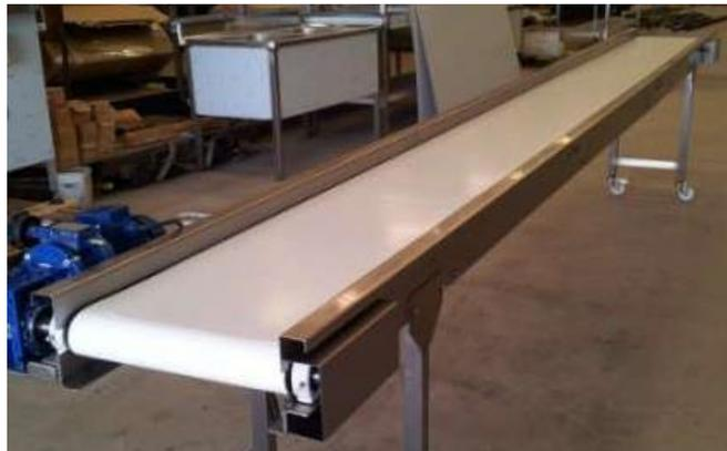
Fig. 10. Cinta transportadora plana [28].
