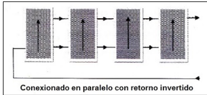
Figura 9. Conexión en paralelo (Fuente: ingemecanica.com)
