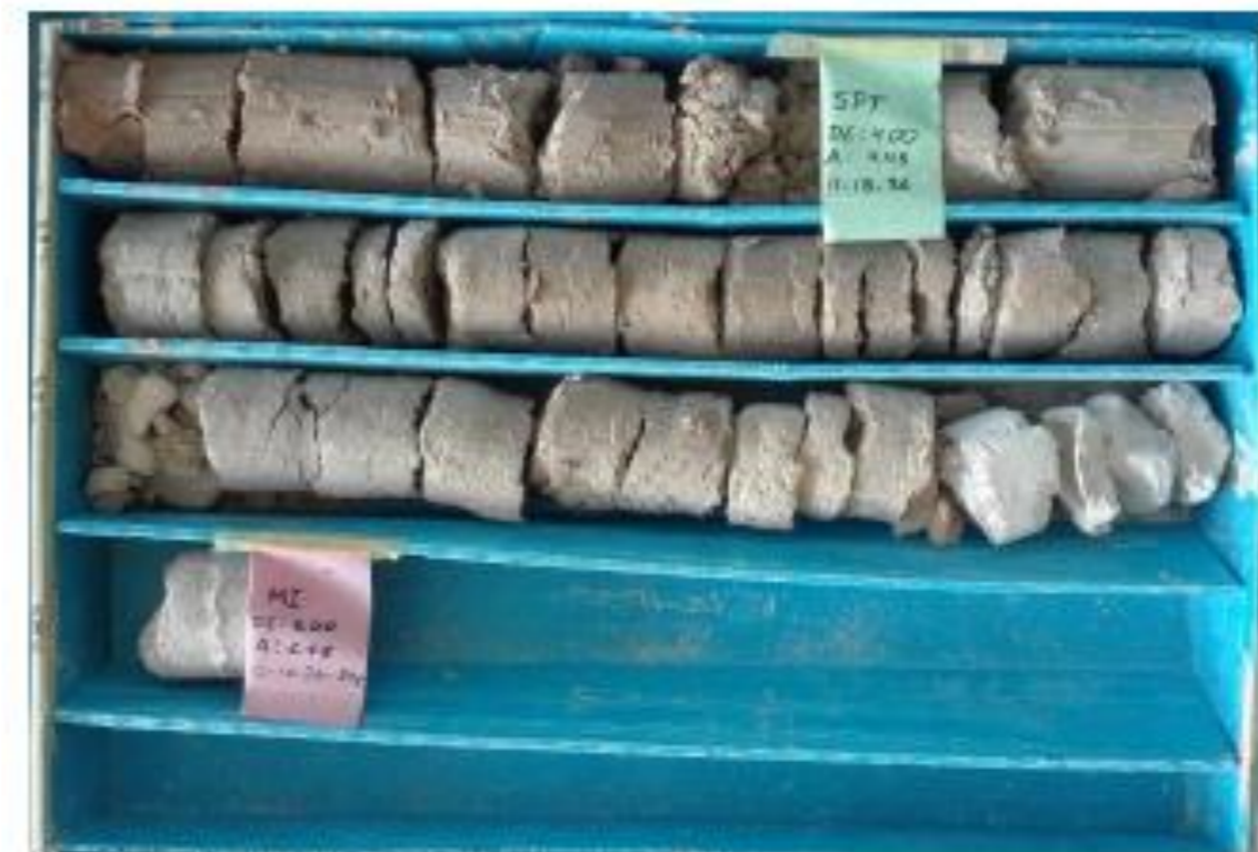
SONDEO 1. CAJA 2/2. 3.60-6.55 m
