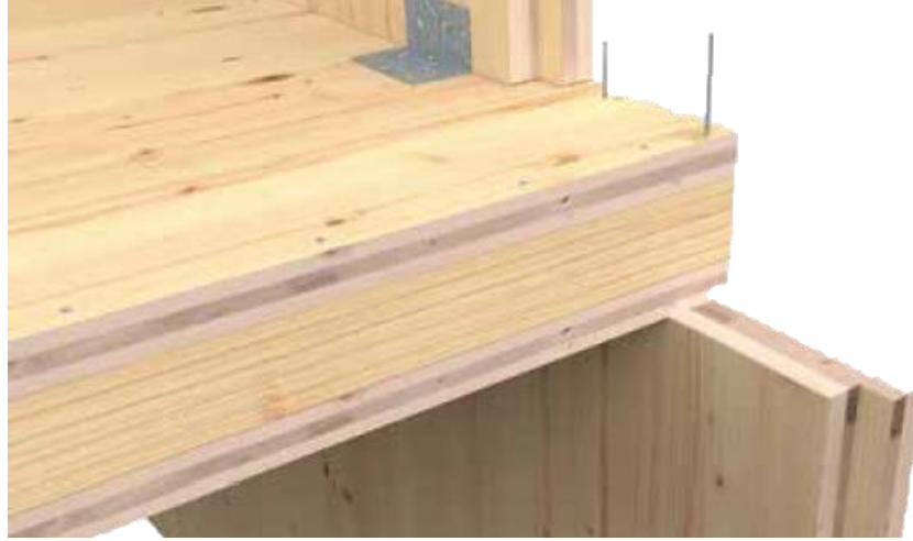
Figura 9. Ejemplo de muros perimetrales de CLT.
