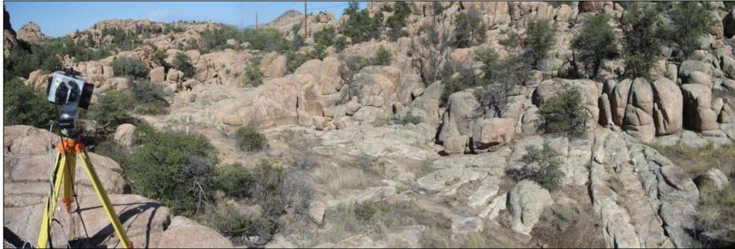
**Figura 25:** Equipo TLS preparado para la toma de datos del terreno. Fuente: Haddad, D. (29 de Octubre de 2019) TLS Applications for Precarious Rock Research. Recuperado de [activetectonics.asu.edu/Precarious\\_Rocks/TLS4PBRs.html](http://activetectonics.asu.edu/Precarious_Rocks/TLS4PBRs.html)
