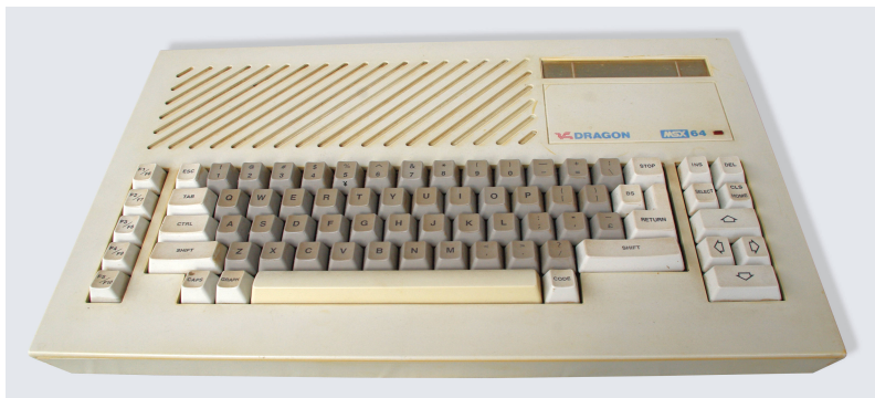
Figura 3.14: En la imagen se observa la presencia de un bloque vertical de teclas de función en la parte derecha del teclado del Dragon MSX.
