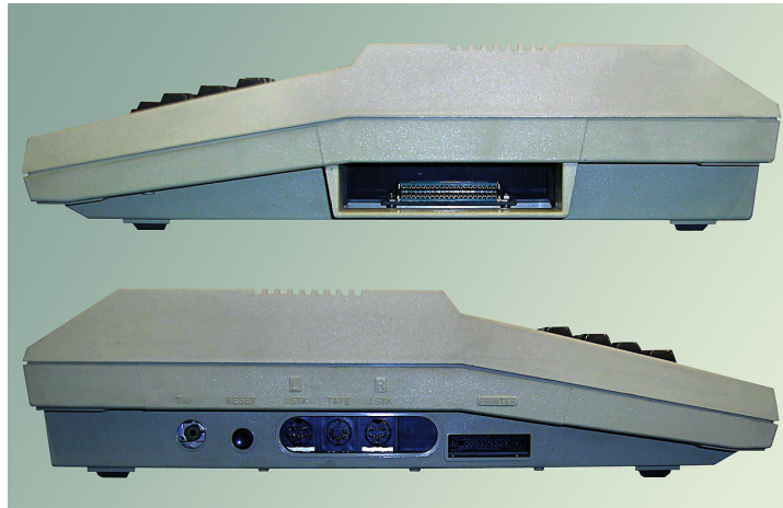
Figura 3.4: En la imagen se muestran las partes laterales del ordenador Dragon 32 donde se encuentran la mayor parte de sus conectores para la periferia.
