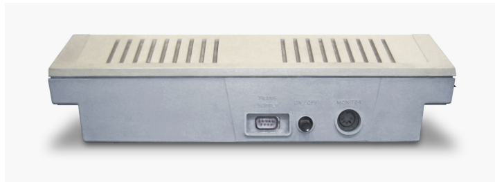
Figura 3.5: En la imagen se muestra la parte lateral del ordenador Dragon 32 donde se encuentra la conexión a la fuente de alimentación, al monitor y el botón de encendido.
