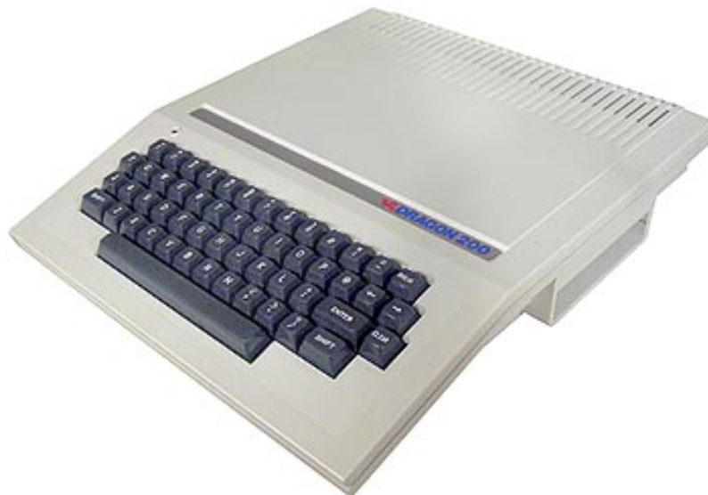
Figura 3.10: En la imagen se observa la nueva carcasa diseñada en España para Dragon 200, la cual es más plana y minimalista.
