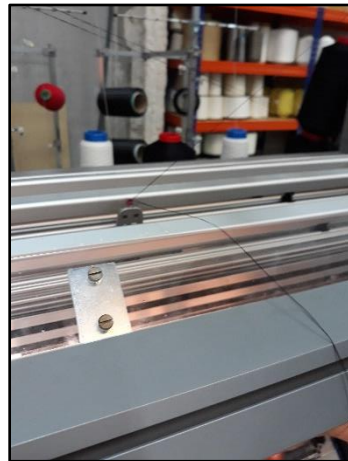
Imagen 91, 92, 93 y 94. Reunido de 4 hilos en el Guíahilos
