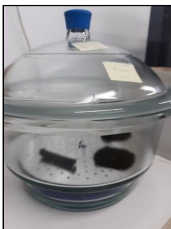
Imagen 138. Probetas en desecador para acondicionar
