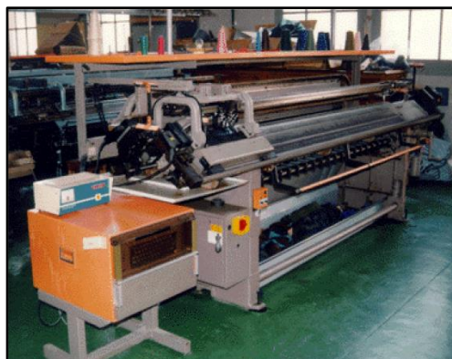
Imagen 77. Detalle del sistema de control en una tricotosa rectilínea
