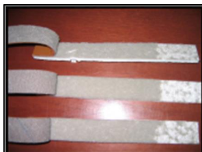
Imagen 16. Aspecto de las probetas tras ensayo de adhesión
