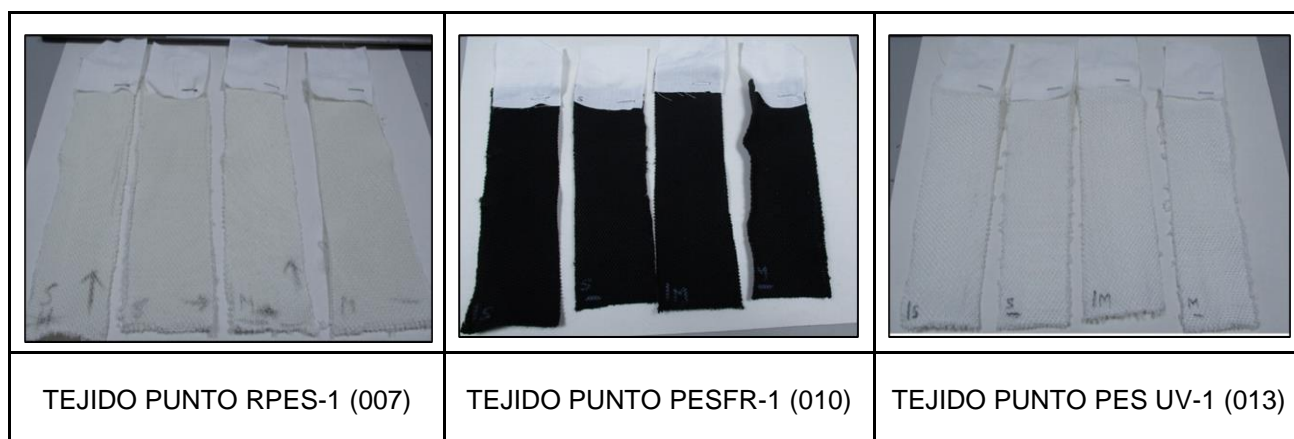
Imagen 134. Fotografías de las probetas ensayadas tras Ensayo de Solidez de las Tinturas al Frote
