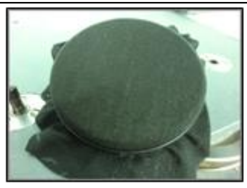
Imagen 124. Ejemplo probeta pilling
