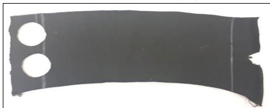
Imagen 130. Fotografías de las probetas tras Ensayo de Combustión
