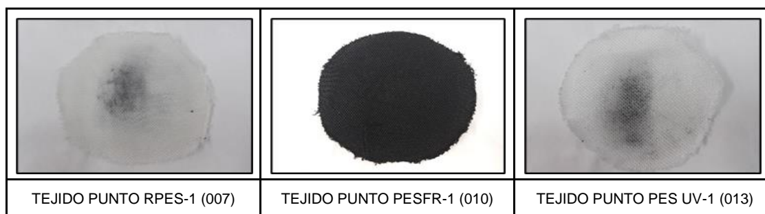
Imagen 131. Fotografías de las probetas tras Ensayo de Ensuciamiento y Limpieza
