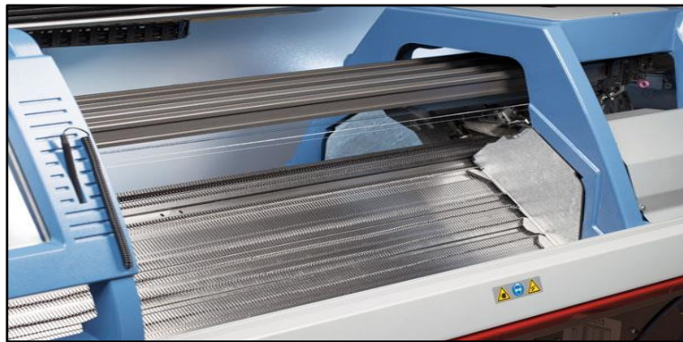
Imagen 67. Detalle de las fonturas de una tricotosa rectilínea
