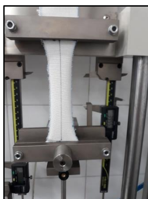
Imagen 142. Probeta sometida a Alargamiento estático
