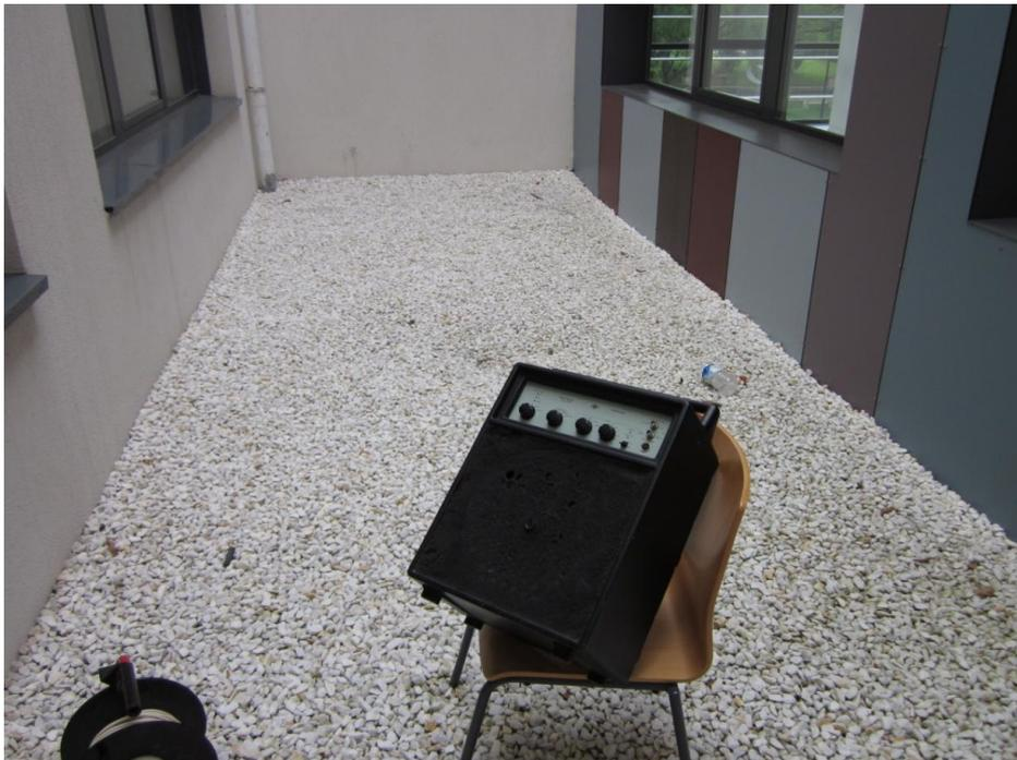
*Figura 33. Foto medición ruido aéreo en fachada.*
