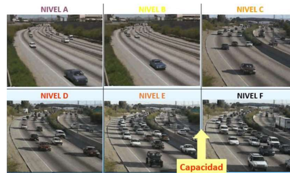
Figura 54. Estado de circulación en cada uno de los niveles de servicio. (Fuente: Highway Capacity Manual 6th edition (2016))
