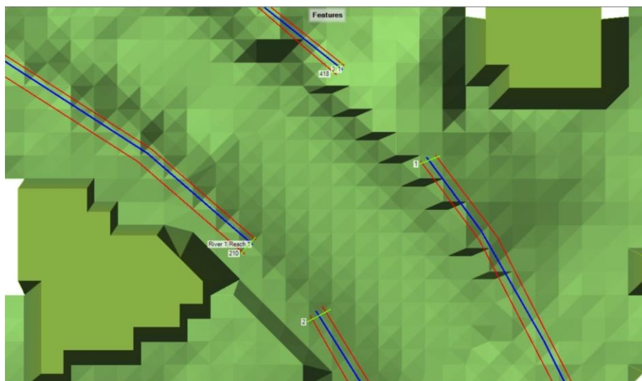
Figura 169. Detalle de la introducción de la geometría de los muros a la altura del puente urbano del Valarties.
