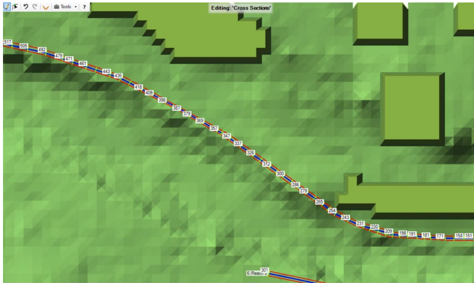
Figura 170. Detalle de la introducción de las diferentes secciones transversales para cada muro.
