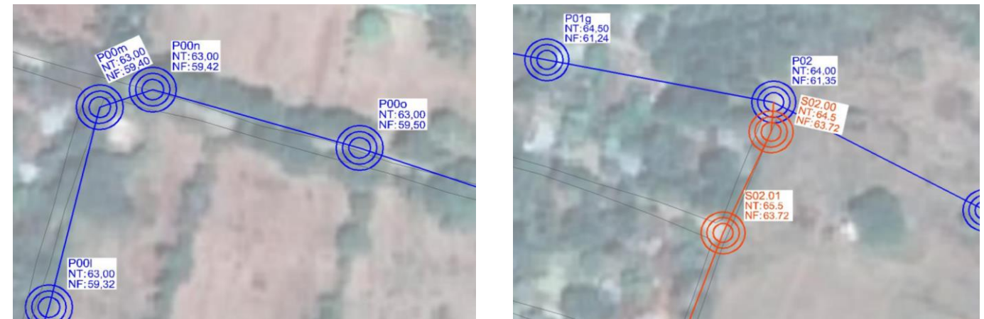
Figura 14. Modificación en planta de los giros de la red se aguas residuales (1). Fuente: Elaboración propia
