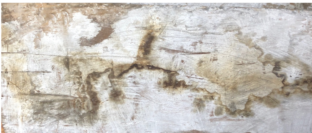
Fig. Anexo 27. Resultados de la limpieza en seco de la policromía de las tablas.
