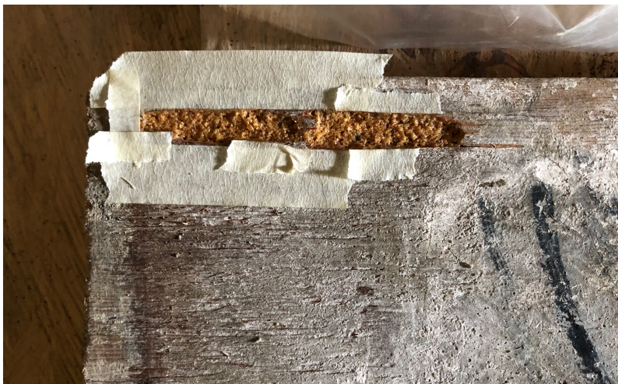
Fig. Anexo 30. Reintegraciones volumétricas del soporte de madera con serrín y PVA.
