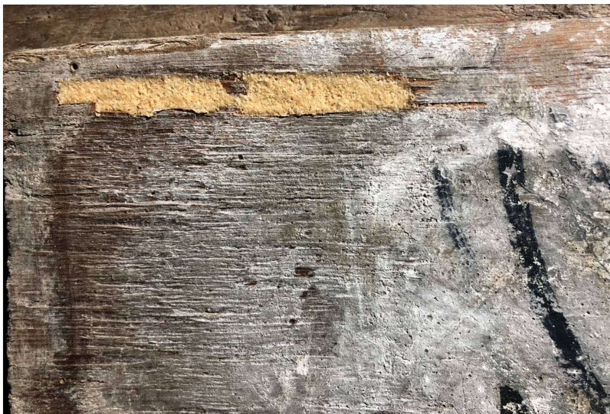
Fig. Anexo 33. Reintegraciones volumétricas del soporte de madera con serrín y PVA.
