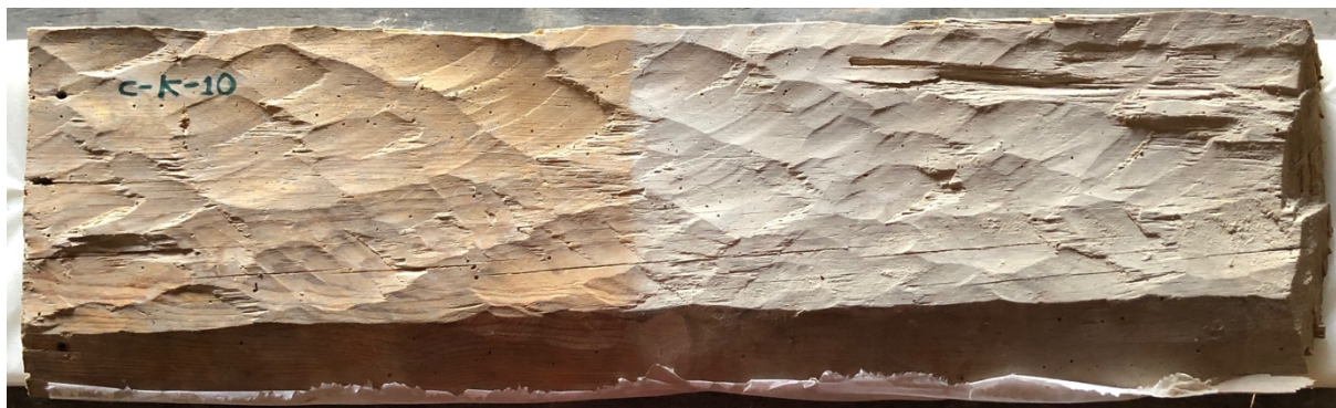
Fig. 34. Resultados de la limpieza en seco del reverso de las tablas.
