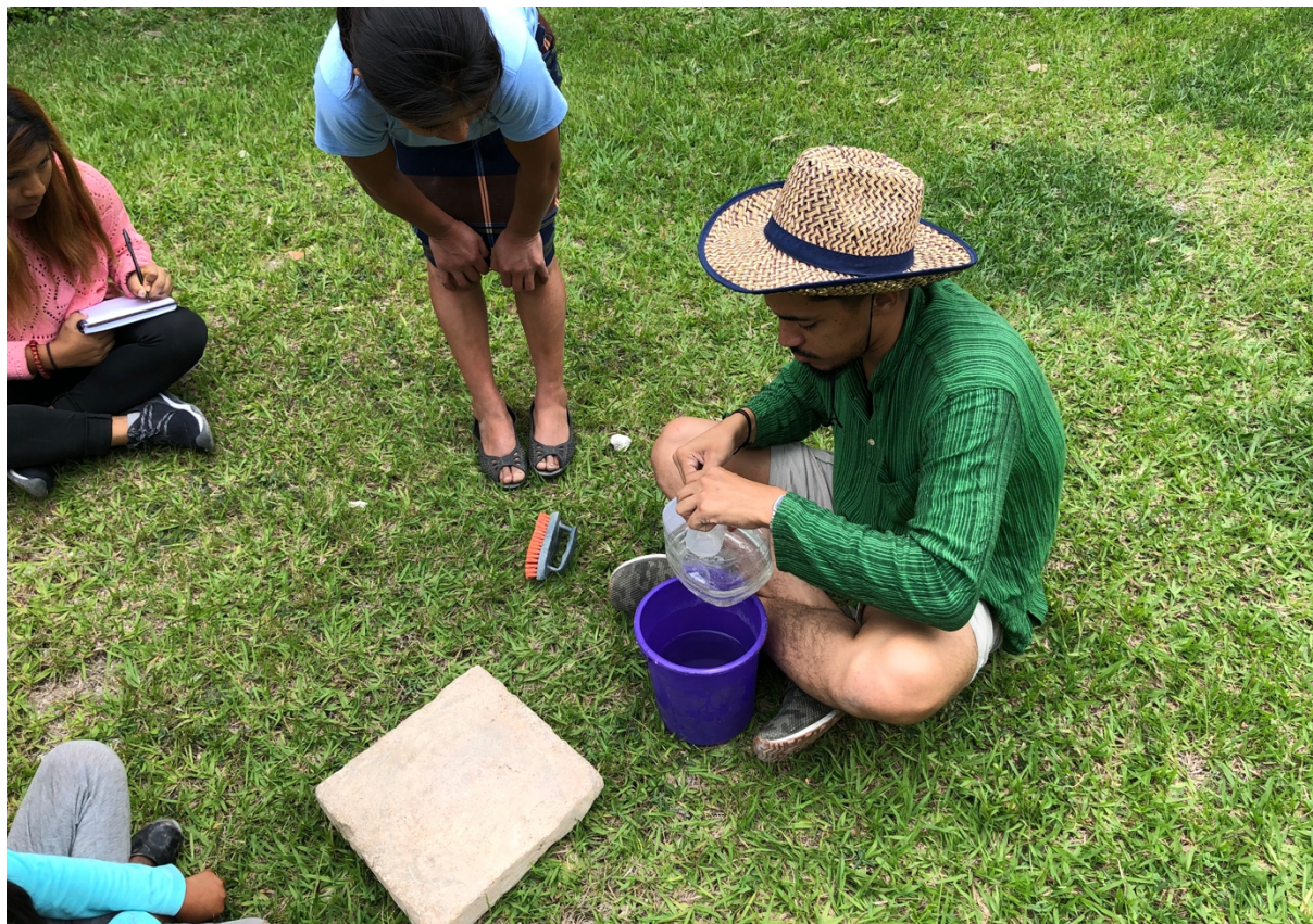
Fig. Anexo 22. Pruebas de limpieza de las baldosas de barro de las capillas laterales de la iglesia.
