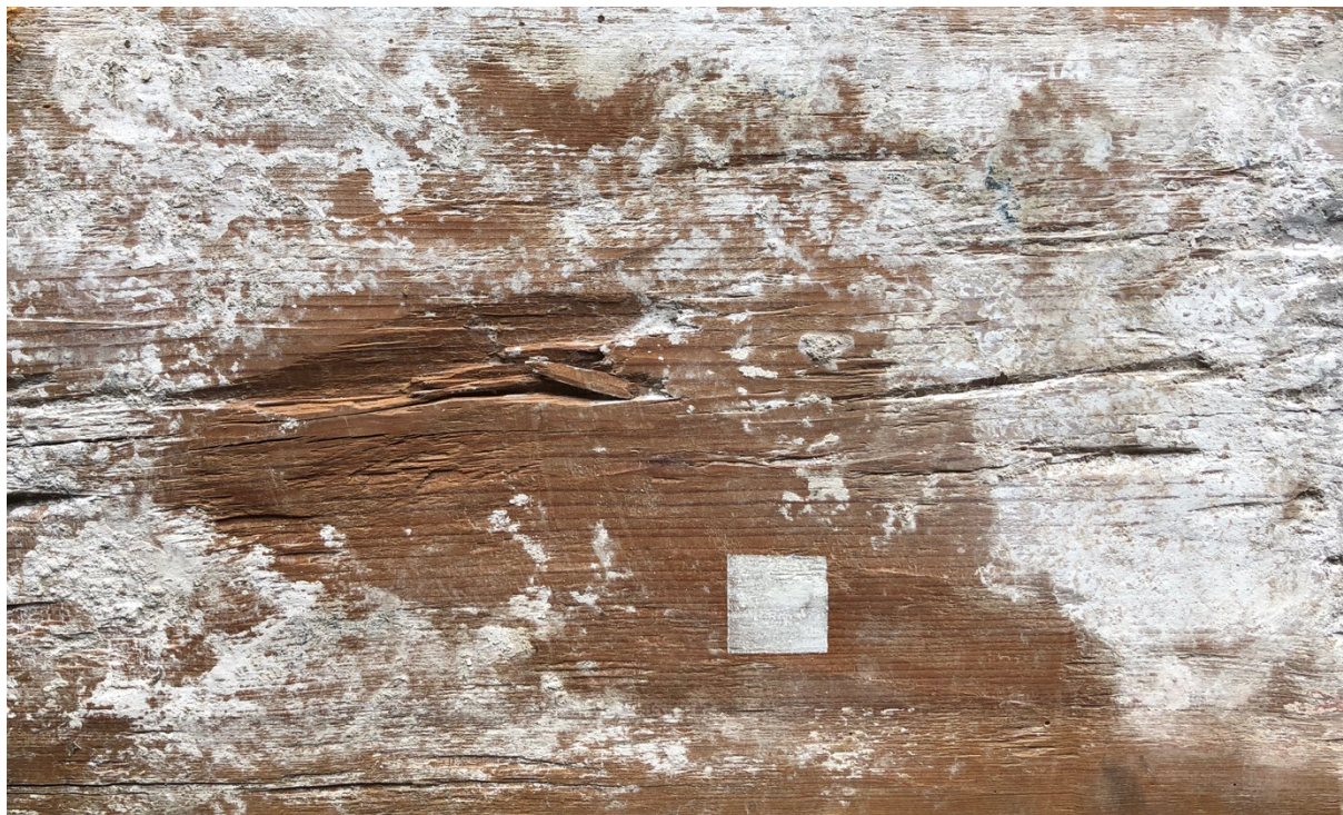
Fig. Anexo 24. Pruebas de color con agua de cal para la reintegración cromática.
