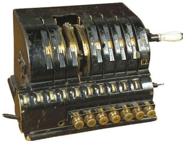
Figura 2.34: primer modelo del aritmómetro de Odhner
