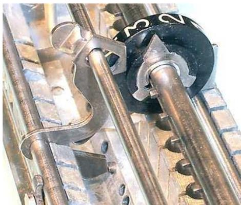
Figura 3.2: palanca del sistema de acarreo
