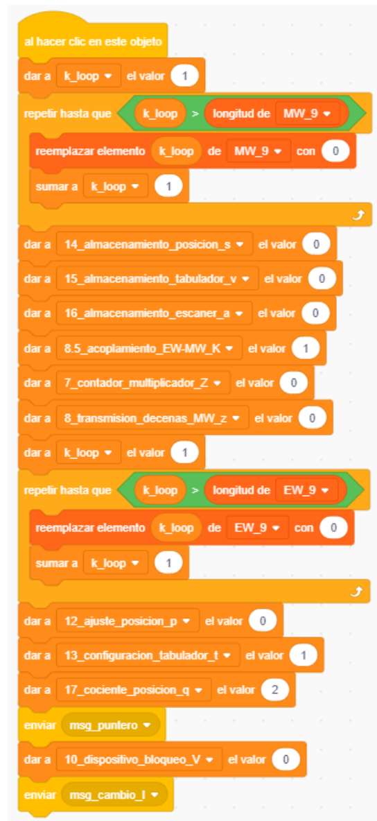
Figura 6.11: Fragmento de código para la limpieza del «Registro configurador». De todos los limpiadores este es el más completo, aplicándose limpieza a los dígitos de los arrays y asignación de valores de inicio a las variables predefinidas.
