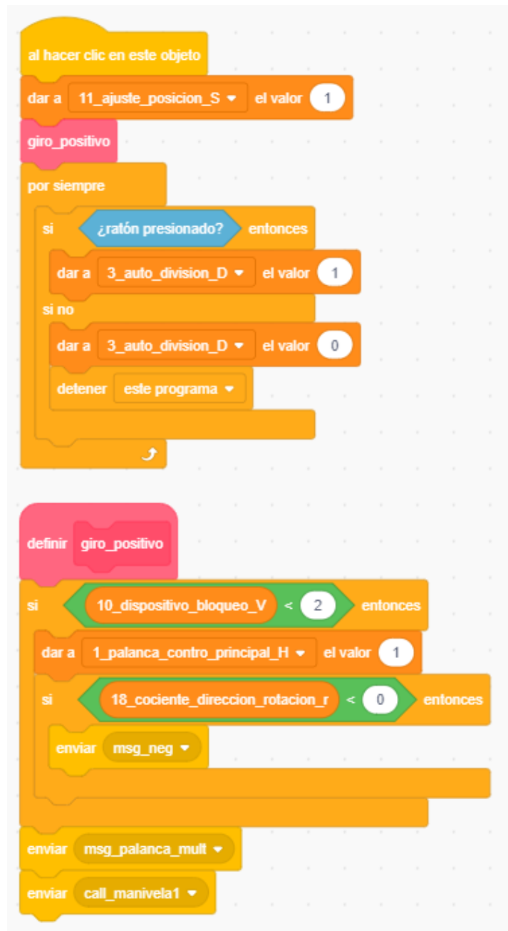
Figura 6.14: Bloques de código utilizados para realizar un giro positivo de manivela en el modelo C1-13. El código es igual para el giro negativo.
