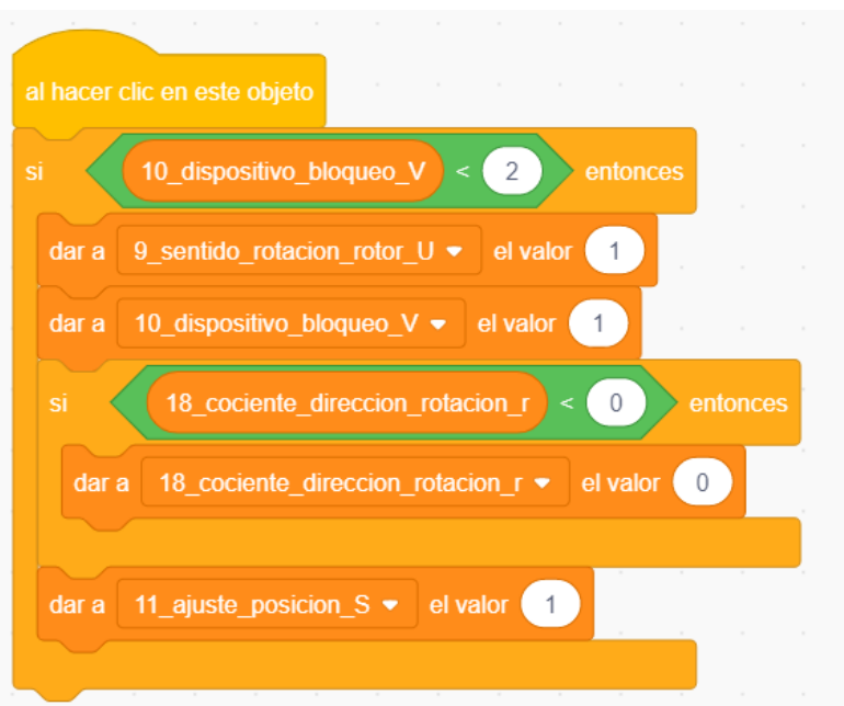
Figura 6.20: Código de la tecla ADD. La variable 9_sentido_rotacion_rotor_U es la encargada de iniciar la operación en la lógica y la variable 18_cociente_direccion_rotacion_r es la encargada de asignar un tipo de giro para realizar una operación determinada.
