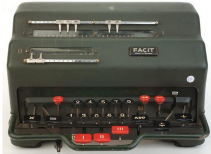
Figura 3.10: Diseño del modelo ESA-0. Esta versión tiene aplicada la patente DE922553 para la realización de multiplicaciones automáticas.
