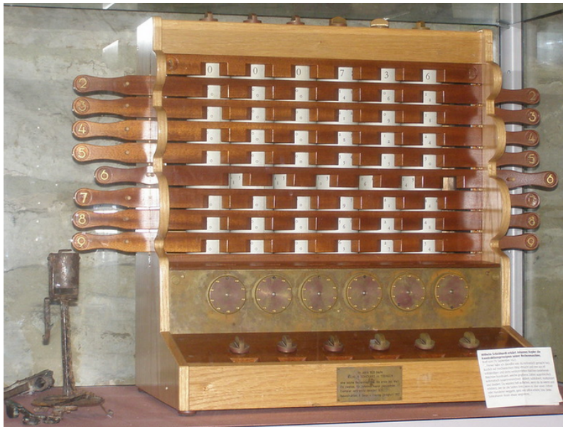
Figura 2.6: Réplica del Reloj Calculador de Wilhelm Schickardt expuesto en el museo Herrenberg (Alemania). Considerado como el primer dispositivo calculador mecánico.
