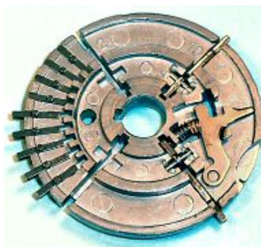
Figura 2.12: Parte del mecanismo pin-wheel con nueve pasadores retráctiles. Los dos pasadores de la derecha son parte del mecanismo de acarreo de decenas.
