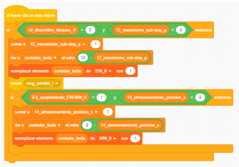
Figura 6.9: Fragmento de código de la tecla numérica 1. El bloque tiene un sistema de bloqueo, evitando inconsistencias o «bugs» a la hora de realizar algún tecleo erróneo.
