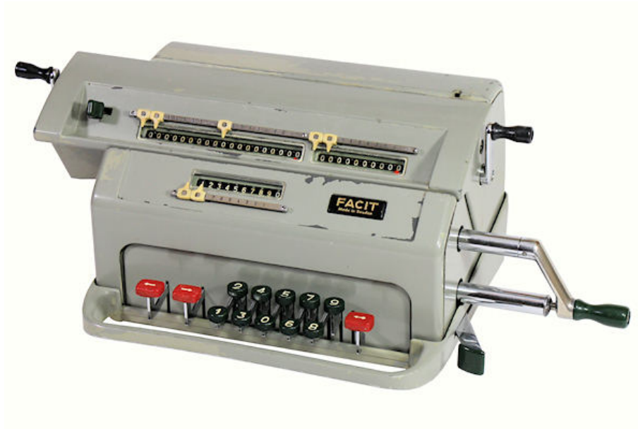
Figura 3.7: Diseño de los modelos LX, NLX y C1-19. Su mecanismo le permite almacenar los resultados a lo largo del acumulador de 19 dígitos.
