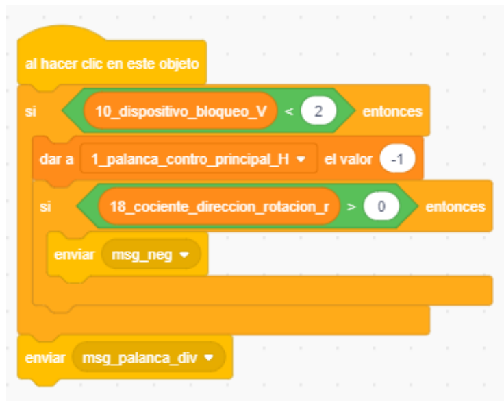
Figura 6.17: Código de la palanca de control deslizable. En este caso el estado de la palanca es «Div», debido a que la variable asignada es -1.
