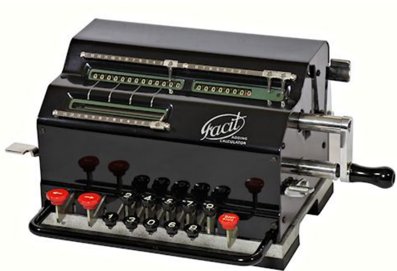
Figura 3.5: Diseño de los modelos T y TK. La “K” proviene del sueco “Kvotkoppling” que significa “cambio de cociente deslizante”. El modelo lleva instalado el teclado Dalton.
