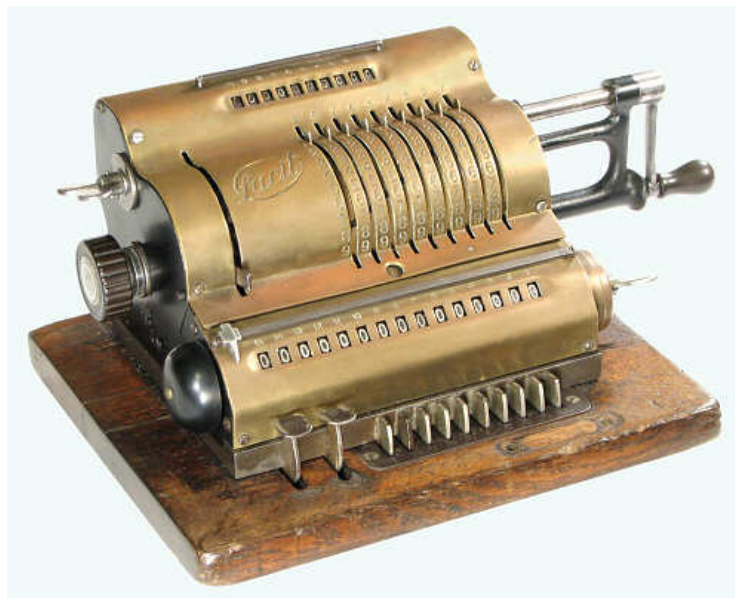
Figura 3.2: Facit modelo Standard. Calculadora basada en el mecanismo Odhner, sin teclado. Los dígitos se introducen con pequeñas palancas que se deslizan verticalmente.
