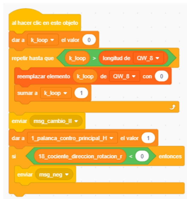
Figura 6.15: Bloque de código utilizado para limpiar el registro multiplicador en el modelo C1-13 . Asigna a cada posición del array el valor 0.
