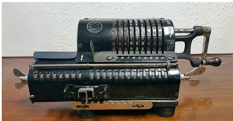
Figura 2.13: Calculadora Brunsviga Modelo A de 1898. Modelo construido a partir del diseño de Odhner (1890) distribuido por Brunsviga.
