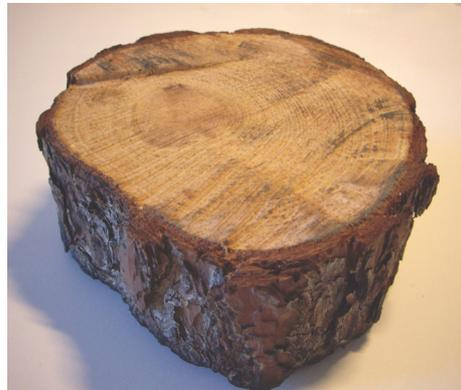
Preparación de las superficies, éstas se han trabajado con una lijadora eléctrica; primero con lija de grano grueso y después con una lija mas fina. Por último se han terminado manualmente utilizando
