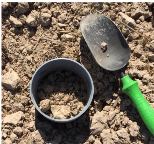
Figura 10. Cilindre per a l'extracció de les mostres de sòl
