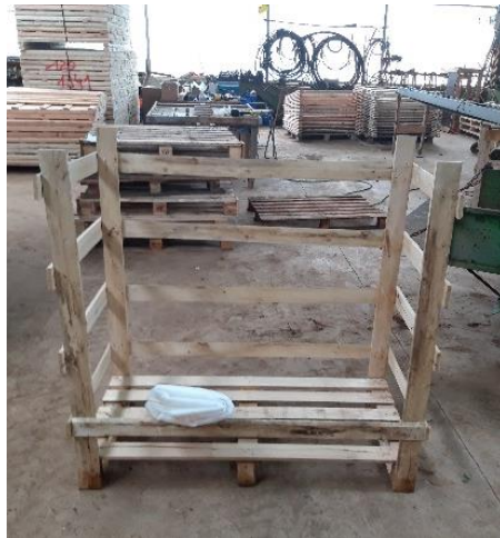
Figura 18: Estructura de palets de la cámara de cría.
