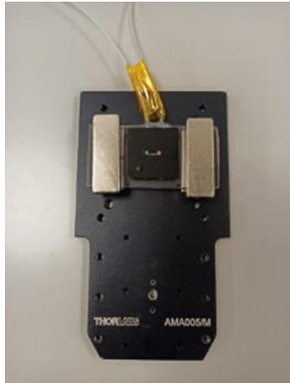
**Figura 54:** Celda de medida realizada para la caracterización de muestras fluyendo en tiempo real.
