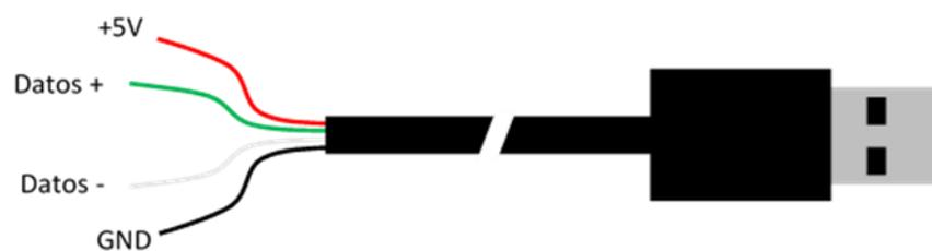
**Figura 27:** Esquema de la disposición interna de los cables de un conector USB
