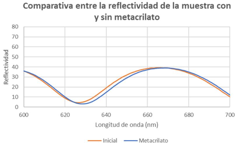
**Figura 56:** Comparativa entre la reflectividad de la muestra con y sin metacrilato medida con el espectrómetro. Se puede apreciar un pequeño cambio en la reflectividad a 659 nm.
