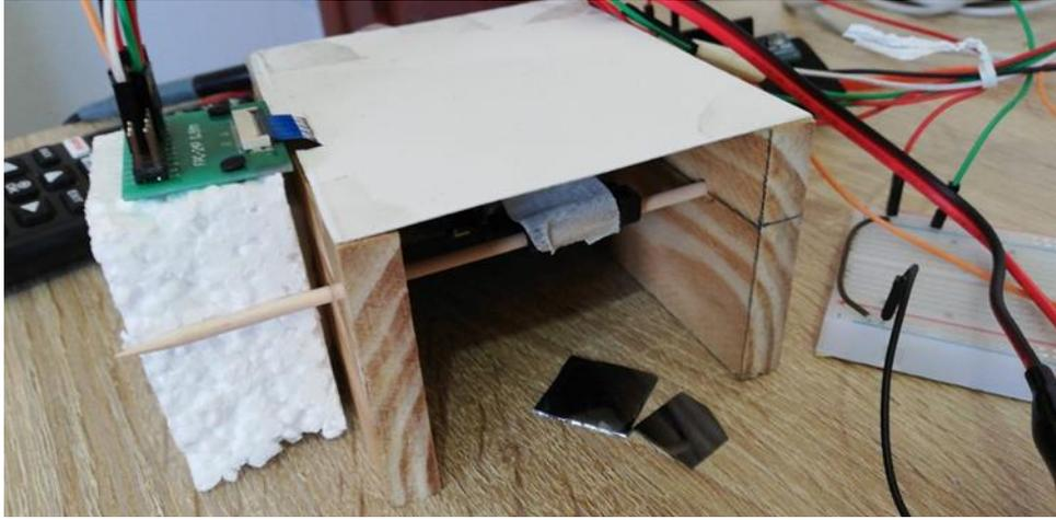
**Figura 25:** Soporte construido para las primeras pruebas junto a dos muestras, un espejo de aluminio y uno de silicio.
