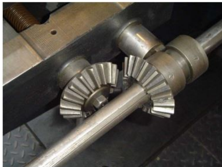
Figura 1.13: Ejemplo de engrane entre dos engranajes cónicos de dientes rectos.
