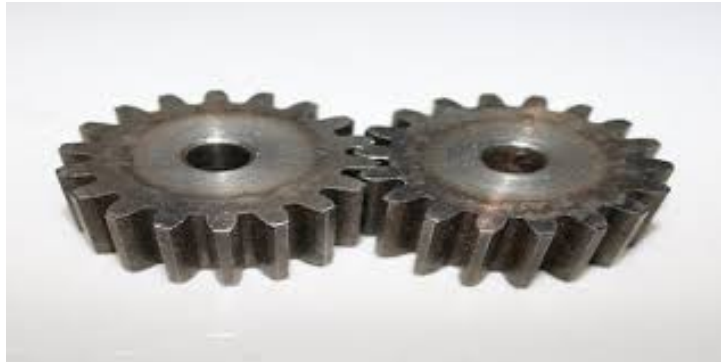
Figura 1.10: Ejemplo de engrane de dos engranajes cilíndricos rectos.
