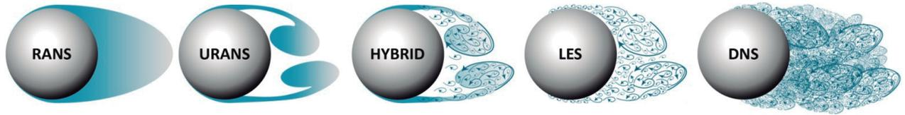
**Figura 2.6:** Detalle de resolución de las diferentes técnicas de simulación CFD.
