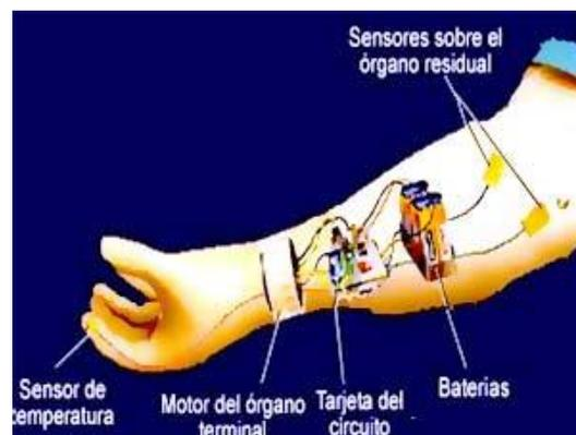
Figura 3: Configuración básica de una prótesis mioeléctrica (tomado de [6]).
