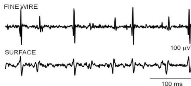
Figura 12: Señal obtenida mediante electrodos intramusculares (arriba) y electrodos superficiales (abajo) (tomado de [26]).
