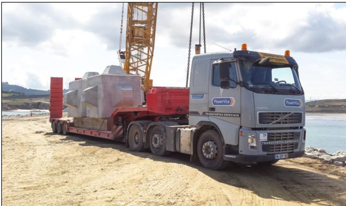
**Figura 7.23.** Transporte de Cubípodos. Fuente: Manual de Cubípedo, 2015
