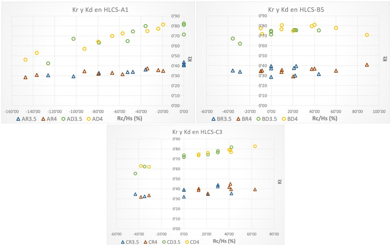
Figura 5.3. Coeficientes de reflexión y disipación en función del parámetro  $R_c/H_s$ . Fuente: Elaboración propia
