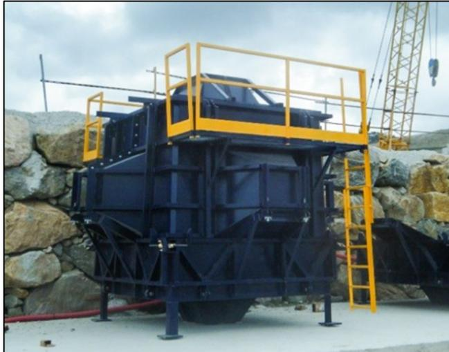
**Figura 7.21.** Encofrado de Cubípodos. Fuente: Manual de Cubípodo, 2015
