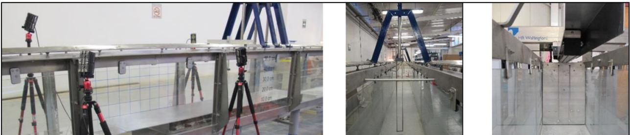
Figura 4.1. Canal de oleaje de la UNAM. Fuente: Odériz et al., 2018
