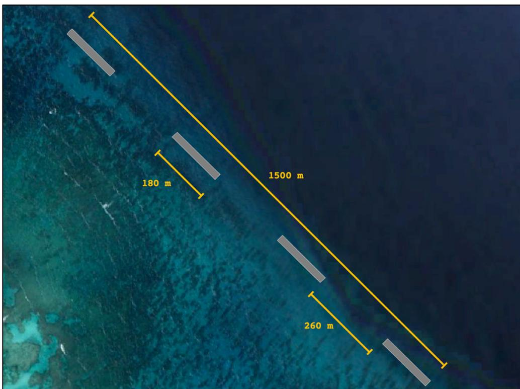
Figura 7.20. Dimensiones en planta del sistema de diques. Fuente: Elaboración propia
