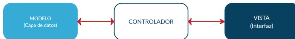
*Figura 25. Esquema de una arquitectura MVC.*
