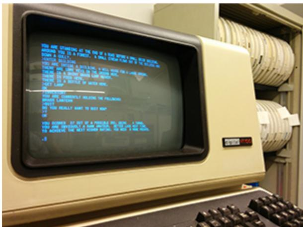
Figura 22. Adventure, ejecutada en un PDP-11, utilizando un terminal VT100 para su visualización.
