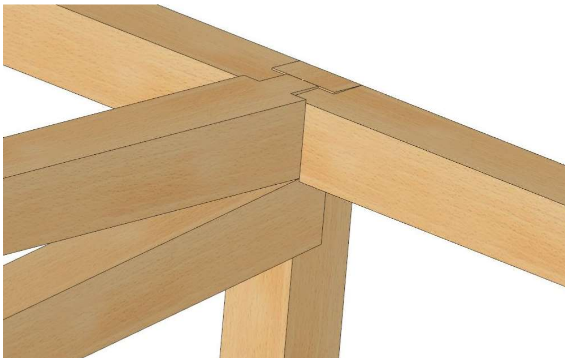
Ilustración 39: Detalle de unión pilar trasero: Pilar-vigas maestras-cercha. Cercha interior. Imagen de Cadwork.
