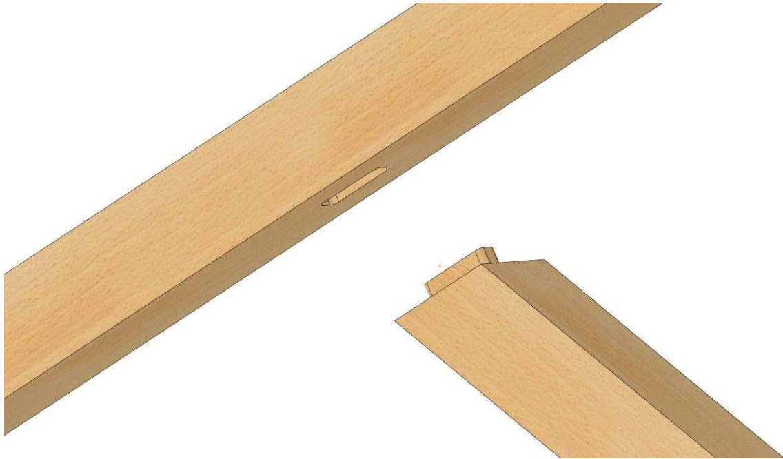
Il·lustració 20: Detalle de unión delantero. Tirante-viga inclinada de la cercha. Explosionado. Imagen de Cadwork.
