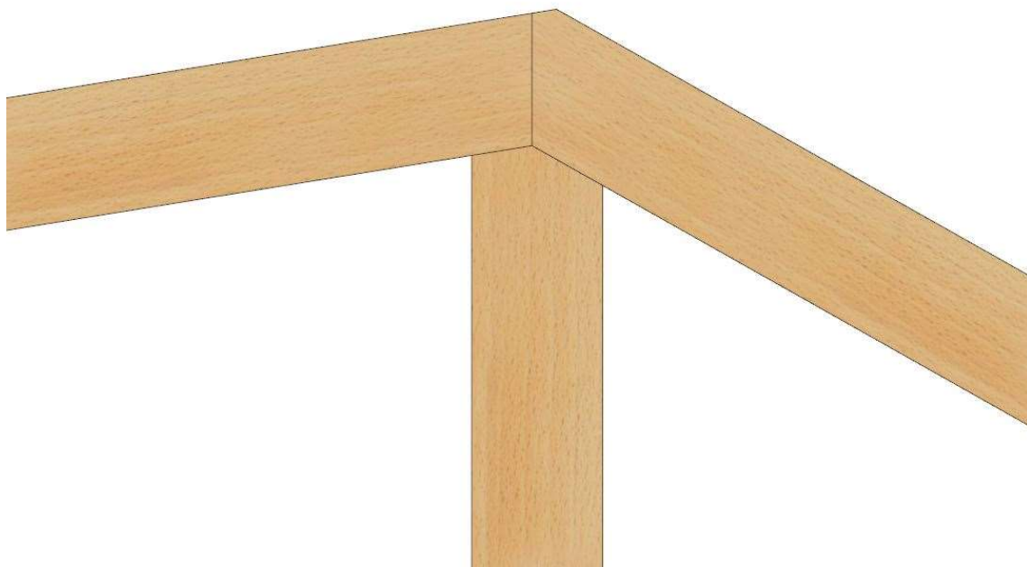
Ilustración 26: Detalle de unión cúspide: Pilar-viga maestra-cercha. Cercha exterior. Falso inglete por la parte exterior de la estructura. Imagen de Cadwork.
