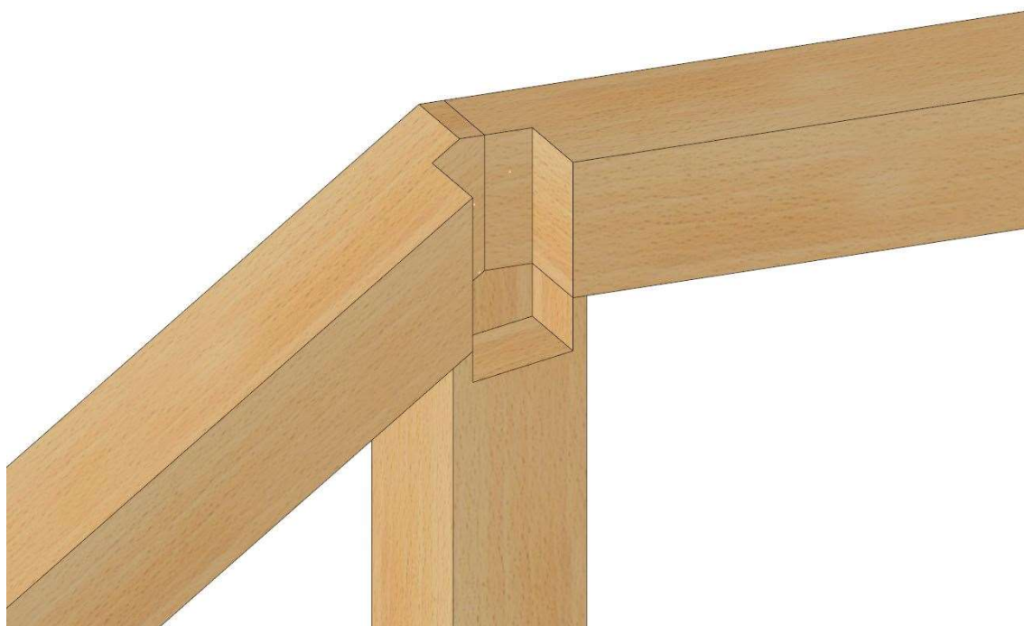
Ilustración 24: Detalle de unión cúspide: Pilar-viga maestra-cercha. Cercha exterior. Sin maestra. Imagen de Cadwork
