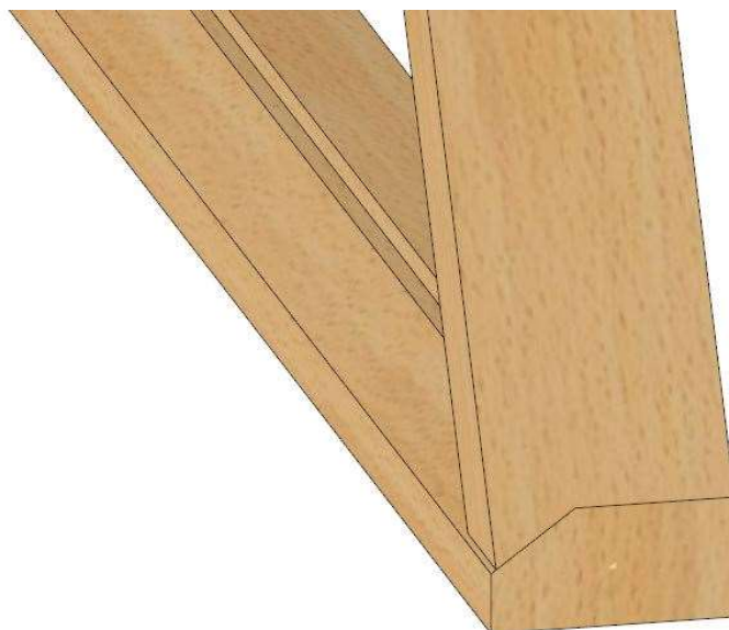
Ilustración 79: Mecanizado en viga vertical de esquinas inferiores de módulo 3 de cerramiento vertical.
