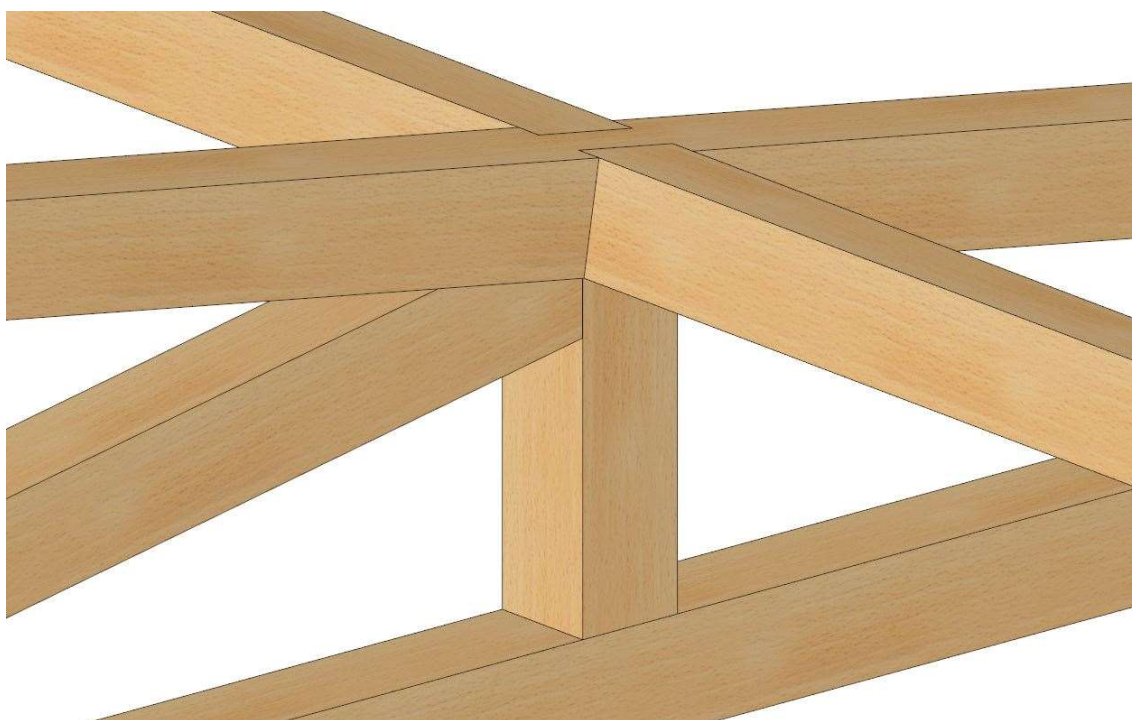
Ilustración 30: Detalle de unión penúltimo pilar: Tirante-viga cercha- pilar. Ambas cerchas. Imagen de Cadwork.
