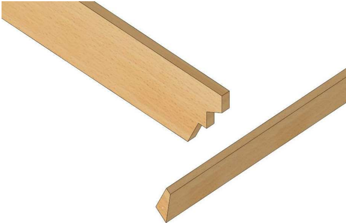
Ilustración 49: Mecanizado de vigueta en zona baja de paño 1 para marco perimetral. Explosionado. Imagen de Cadwork.
