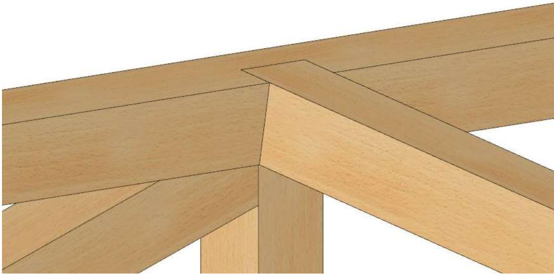
Ilustración 31: Detalle de unión penúltimo pilar: Tirante-viga cercha-pilar. Cercha exterior. Imagen de Cadwork.
