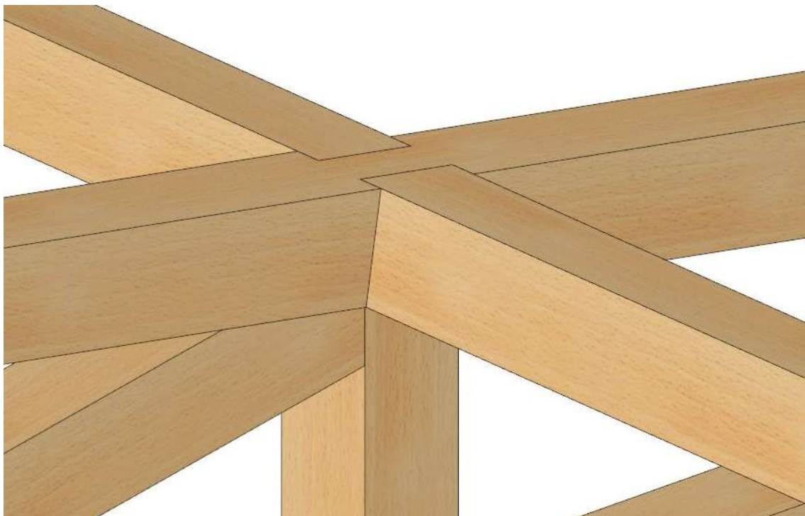
Ilustración 33: Detalle de unión penúltimo pilar: Tirante-viga cercha-pilar. Cercha interior. Imagen de Cadwork.
