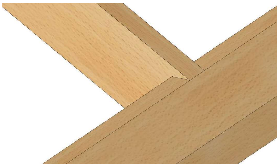
Il·lustració 41: Detalle de unió entre la primera viga maestra y las viguetas. Imagen de Cadwork.
