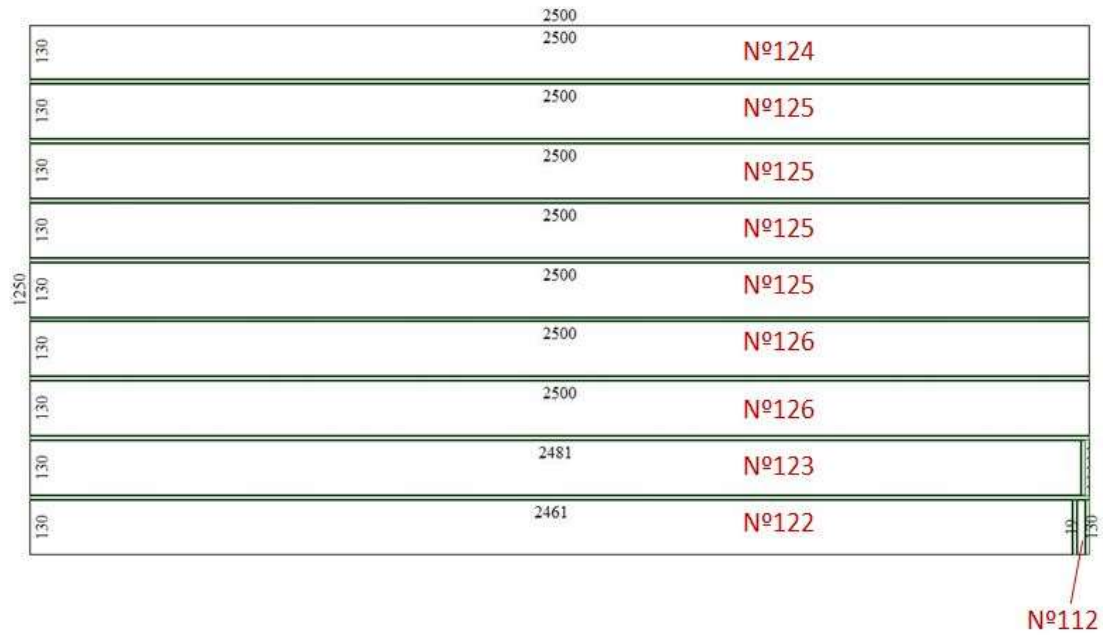
Il·lustració 122: Optimización de tablero contrachapado 8 -1 Ud.
