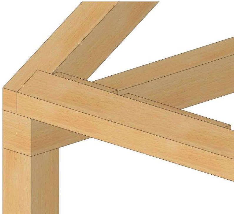
Ilustración 15: Detalle de unión delantera: Pilar-maestra-cercha. Cercha exterior.
