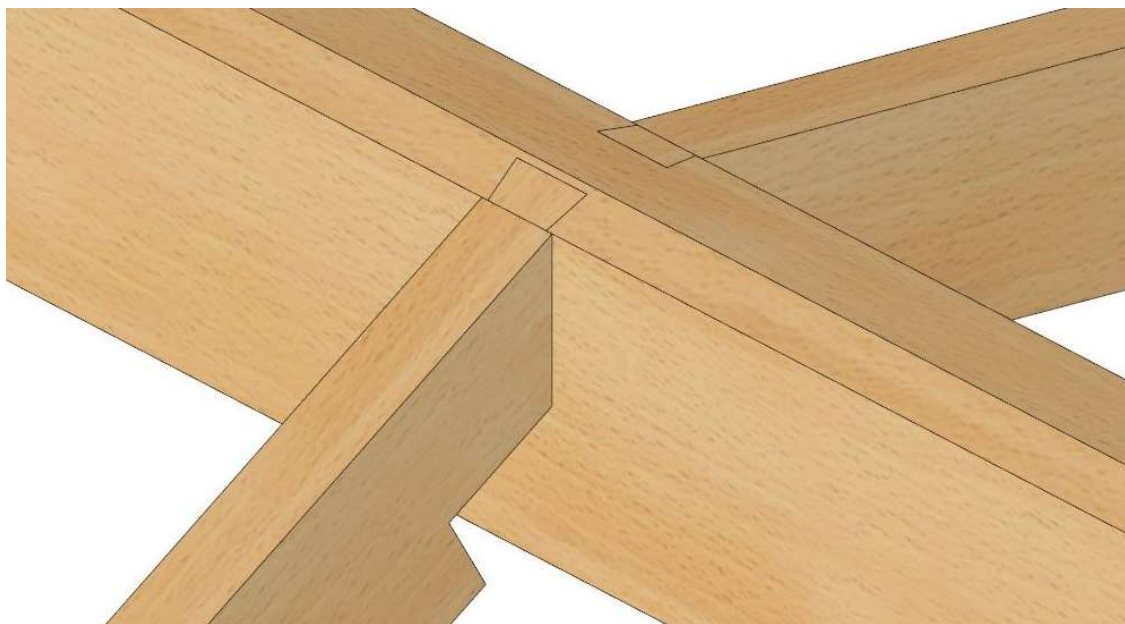
Ilustración 43: Detalle de unión entre viga cumbrera y viguetas mediante cola de milano. Imagen de Cadwork.
