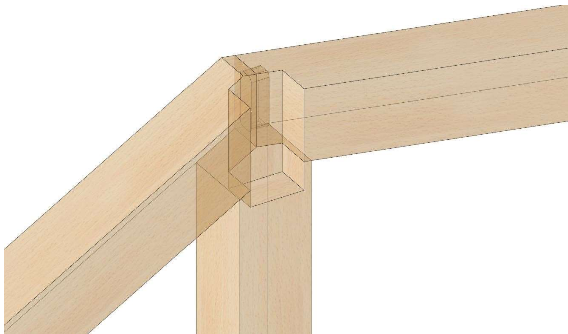
Ilustración 25: Detalle de unión cúspide. Pilar-viga maestra-cercha. Cercha exterior. Transparencia sin maestra. Imagen de Cadwork.
