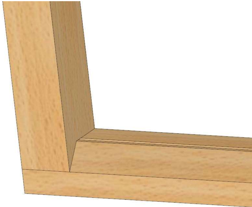
Il·lustració 78: Mecanizado en viga vertical de esquina inferior izquierda del módulo 2 de cerramiento vertical.
