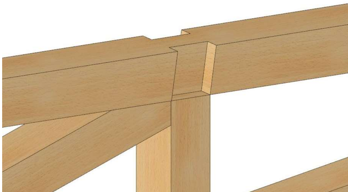
Ilustración 34: Detalle de unión penúltimo pilar: Tirante-viga cercha-pilar. Cercha interior. Sin maestras. Imagen de Cadwork.
