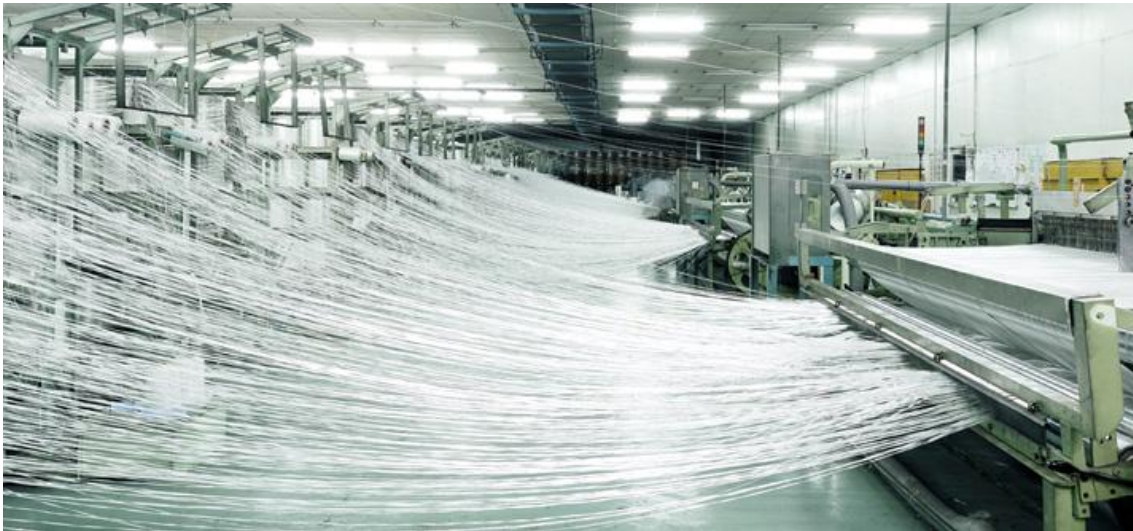
Figura I.16 Producción, estirado y tejido de fibras de vidrio 13 .
