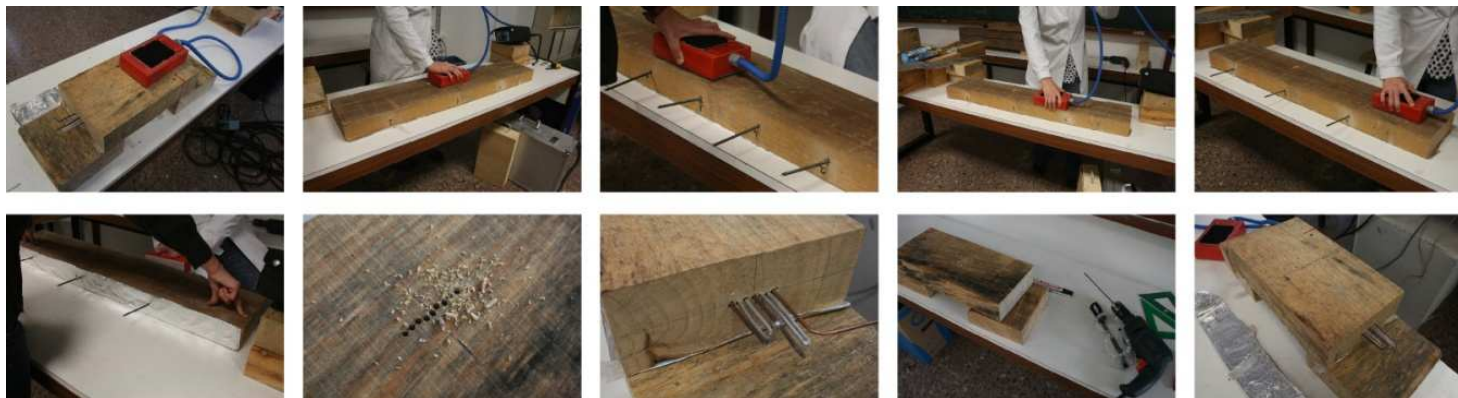
Ensayos con georadar.
