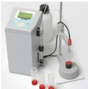
Figura 12: pHmetro CRISON PH-Matic 23 (Fuente: CRISON Instruments).
